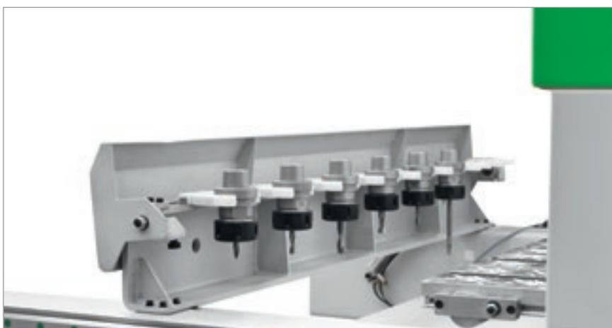
Tempi di lavorazione ridotti grazie al magazzino cambio utensili con 7 (Rover JFT 1224) o 8 (Rover J FT 1530) posizioni.
