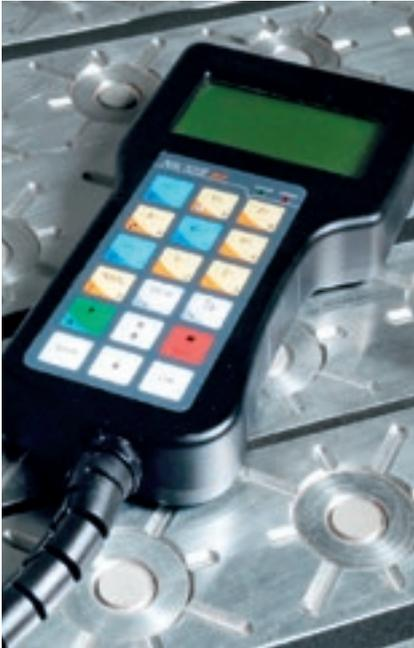
Controllo remoto DSP per un controllo diretto ed immediato da parte dell'operatore.
