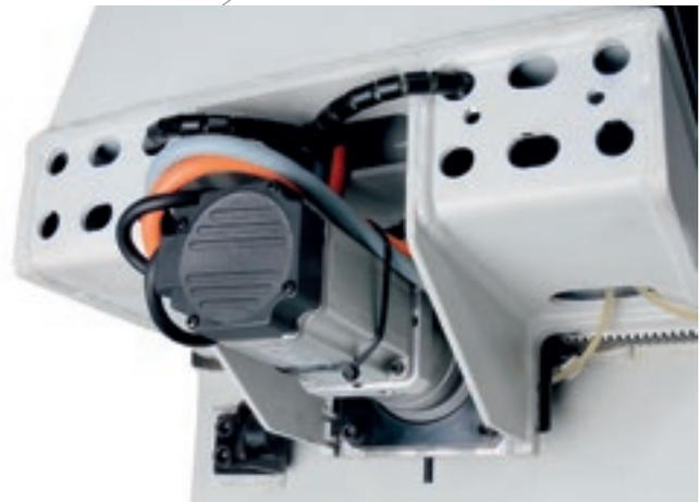
La doppia motorizzazione in asse X permette di supportare alta velocità, garantendo un'alta precisione e qualità di finitura.
