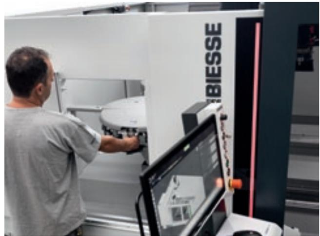
1 Revolvermagazin mit 16 von der Stirnseite leicht zugänglichen Standardpositionen, eine zweite Magazinoption mit 16 Positionen für insgesamt 32 Plätze.
