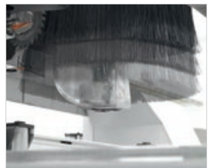
Deflector (transportador de aparas) controlado por controlo numérico.
