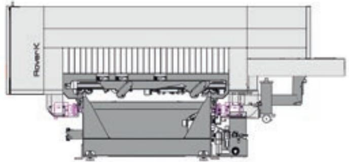
La double motorisation dans l'axe X permet d'atteindre des vitesses et des accélérations élevées tout en préservant une haute précision et une grande qualité de finition.
