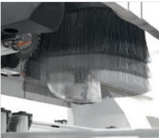
Coiffe d'aspiration réglable sur 6 positions permet un nettoyage constant du produit et de la zone autour de la machine.
