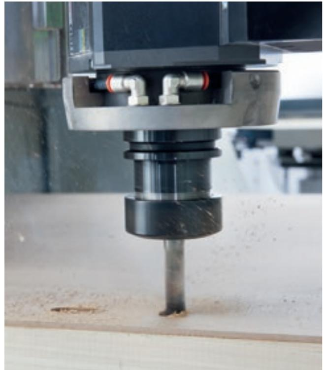
Rover K Smart est équipé de 3 ou 4 axes indépendants et interpolants et peut être équipé d'agrégats capables d'exécuter tous types d'usinage sur les panneaux et les éléments en bois massif.
