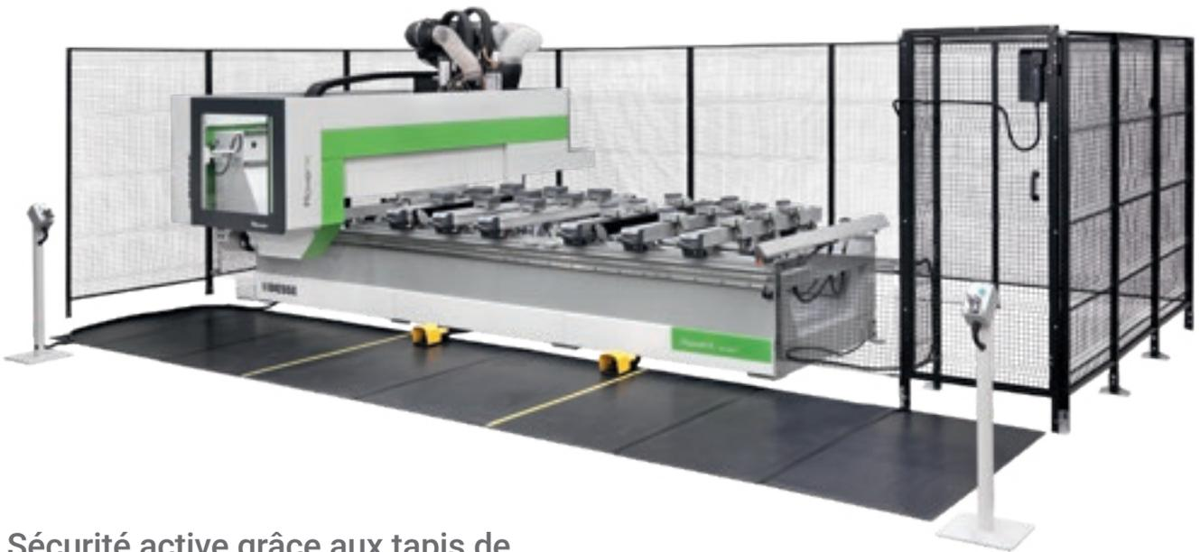
Sécurité active grâce aux tapis de détection sensibles: la machine continue à travailler toujours à la vitesse maximale et constante même lorsque l'opérateur est présent.
