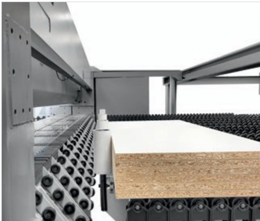
Die Paketstreifen werden zur Queraufteilung in Abhängigkeit des Schnittzyklus transportiert der durch die NC vorgegeben wird.
