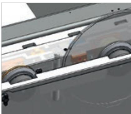
Il dispositivo antisbandamento controlla la posizione e il numero di giri della lama intervenendo sulla velocità di avanzamento. **Massima qualità** di taglio, **maggiore vita della lama** e **riduzione dei costi di manutenzione**.
