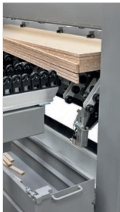
I refili longitudinali vengono evacuati tramite una apposita botola completamente automatica costituita da rotelle folli.
