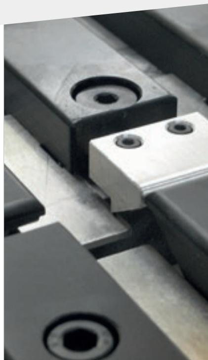
Sistema di chiusura della linea di taglio per evitare la caduta dei refili longitudinali.
