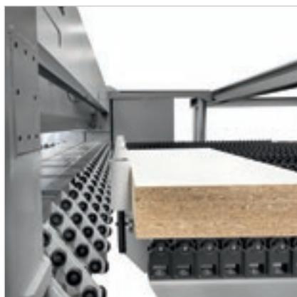
Продольные обрезки эвакуируются при помощи соответствующего люка с бесприводными роликами, работающего полностью автоматически.
