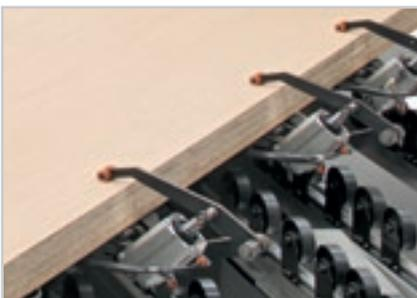
Устройства фиксации панелей, предотвращающее сдвиг панелей в стопе при её повороте.
