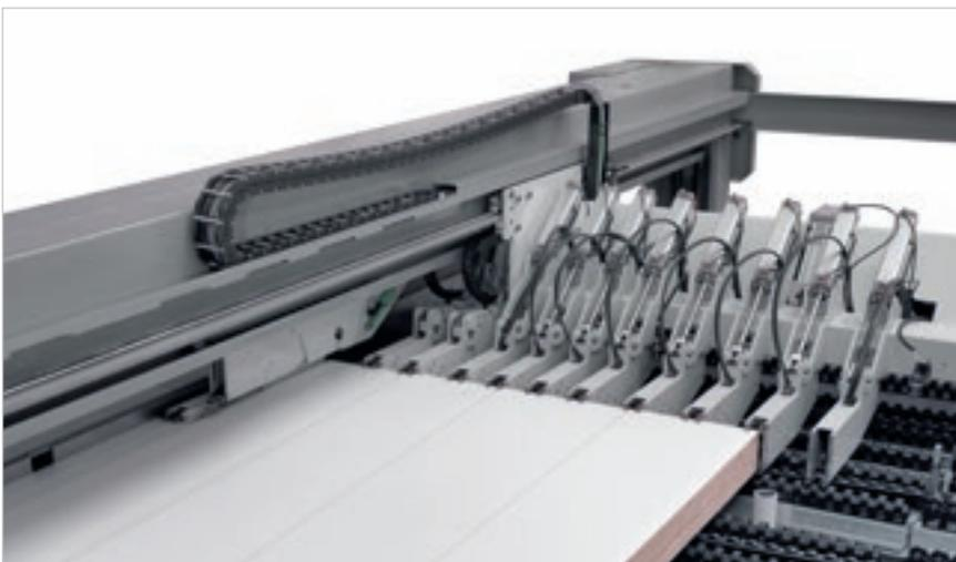
Две станции раскроя полностью независимы при исполнении схем раскроя благодаря промежуточной зоне, способной принимать целый лист. Обе зоны полностью покрыты роликами для предохранения поверхности панелей.
