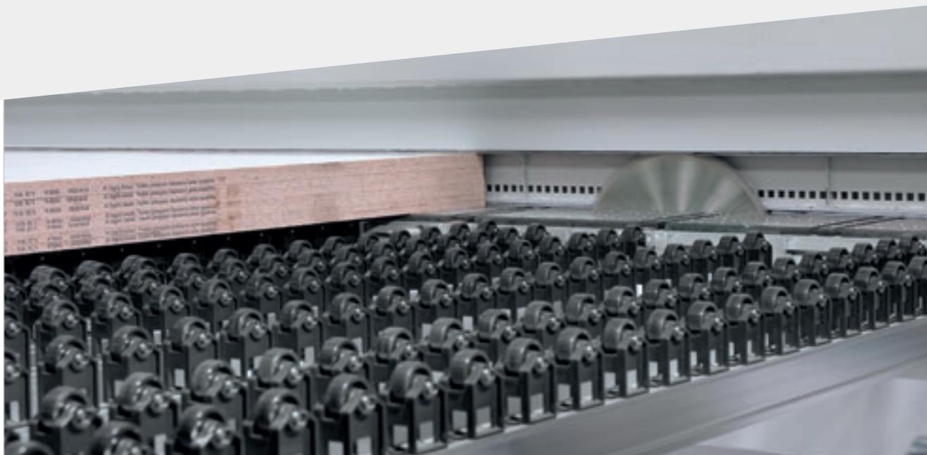
Прижим имеет двоякую независимую структуру, позволяющую производить равномерное и управляемое прижатие пачки раскраиваемых панелей благодаря отсутствию вырезов для ввода зажимов и созданию самой настоящей герметичной камеры при отделении обрезка, что даёт возможность получать эффективную работу вытяжки опилок.
