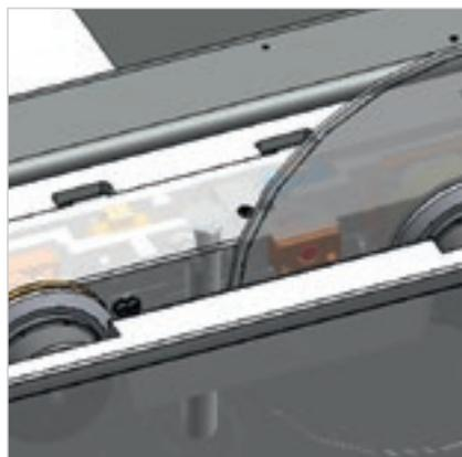
Устройство предотвращения изгиба контролирует положение и скорость вращения пилы, воздействуя на скорость подачи. Максимальное качество реза, увеличенный срок службы пилы и снижение затрат на обслуживание.
