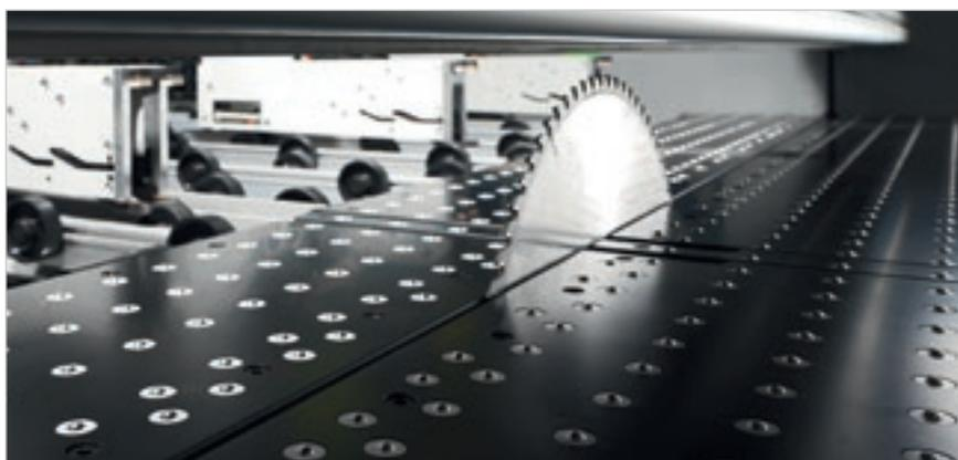
Рабочий стол с воздушной подушкой над станиной для перемещения деликатных материалов. Это свойство позволяет, кроме того, поддерживать в постоянной чистоте плоскость рабочего стола в непосредственной близости от траектории пилы.
