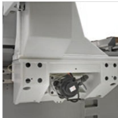
Die **Doppelmotorisierung in der X-Achse** ermöglicht das Erreichen hoher Drehzahlen und Beschleunigungen, wobei hohe Präzision und Oberflächenqualität beibehalten werden.
