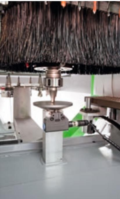
Reduzierung der Zeiten für die Maschinenbestückung, ohne Fehler von Seiten des Bediener, dank des **Kontakt-Voreinstellgeräts**, das es ermöglicht, die Messung der Werkzeuglänge automatisch durchzuführen.
