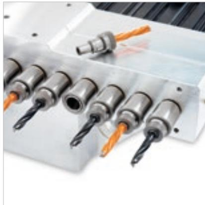
Auswechseln der Bohrer einfach und schnell dank des exklusiven Schnellwechselsystems an den Spindeln.
