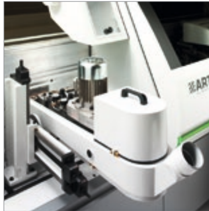
Ziehschleifaggregat zum Schleifen der Holzkante.
