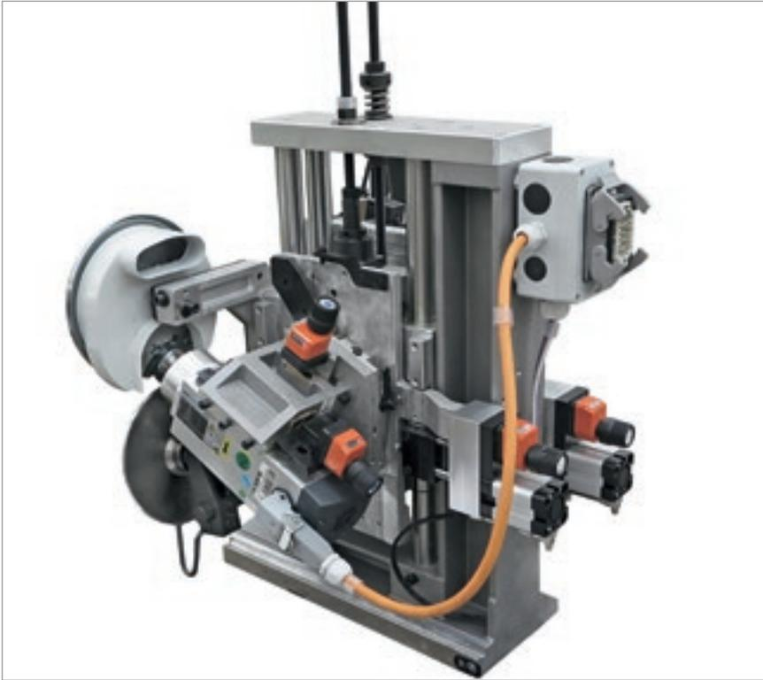
**Groupe de chanfreinage** pour l'affleurage du chant, équipé de 2 moteurs à haute fréquence et copieurs verticaux / horizontaux à disque rotatif.
