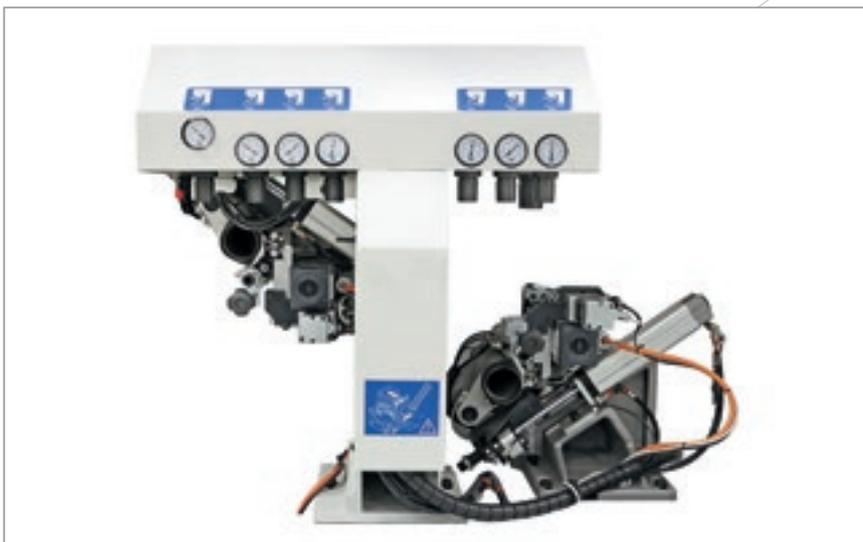
Le **Groupe arrondisseur** multifonction permet d'appliquer un rayonnage non seulement dans la partie supérieure et inférieure du panneau mais aussi sur la tête et la queue.
