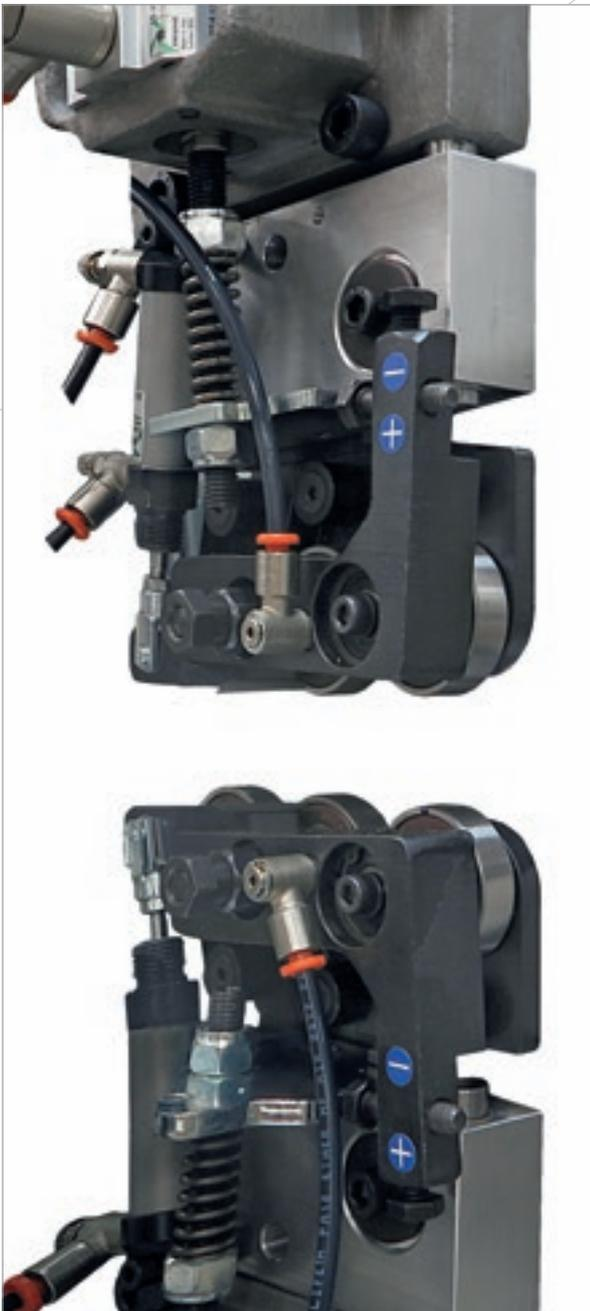
Le **Groupe racleur de colle** sert à éliminer les excès de colle dans la partie supérieure et inférieure du panneau, il s'agit du seul groupe présent sur le marché à être muni de 4 cylindres pneumatiques pour une haute qualité de finition.
