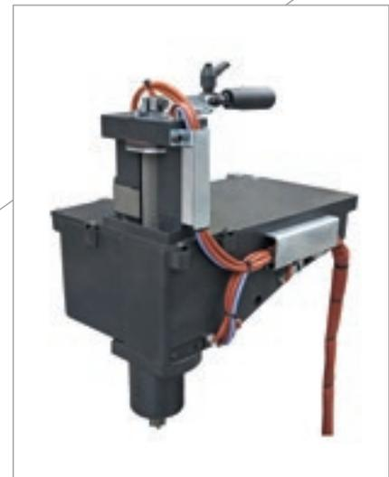
Le **bac colle** dispose d'un système de précopiage pour éviter le contact direct entre rouleau et panneau en maintenant la qualité du panneau usiné et en permettant un étalage continu de la colle sans usure du bac colle.
