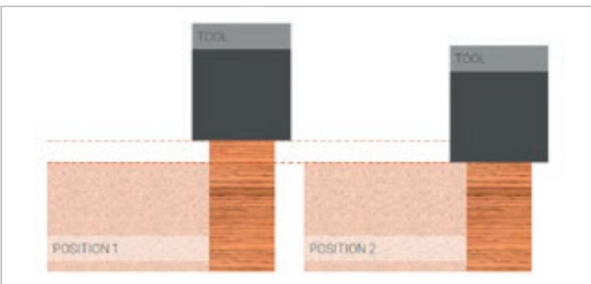
Duo System est un dispositif pour le changement automatique entre la fonction de corroyage et celle de finition.
