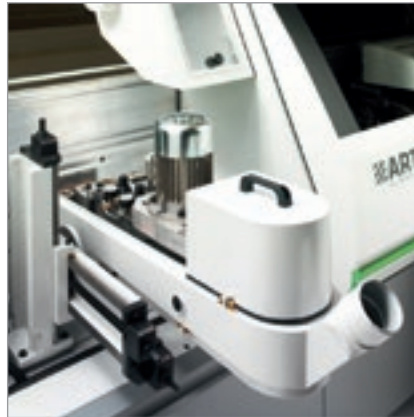
Gruppo Levigatore per la levigatura del bordo in legno.
