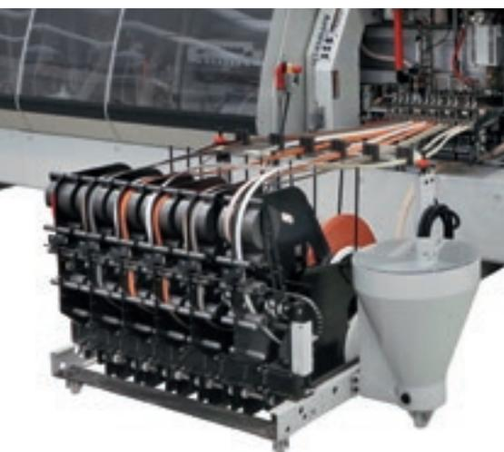
Magazzino per la gestione multipla dei bordi. Grazie ad un magazzino in grado di ospitare un'elevata combinazione di bordi, il gruppo garantisce flessibilità senza precedenti.
