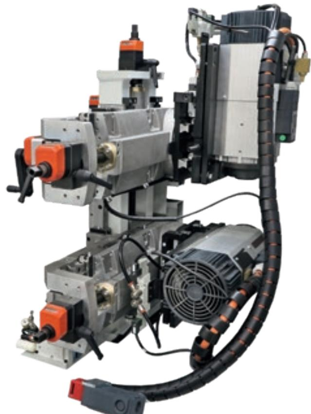
**LE GROUPE DE FRAISAGE PERMET DE RÉALISER LE RAINURAGE ET LE FRAISAGE SUR LA SURFACE INFÉRIEURE, SUPÉRIEURE ET FRONTALE DU PANNEAU.**
