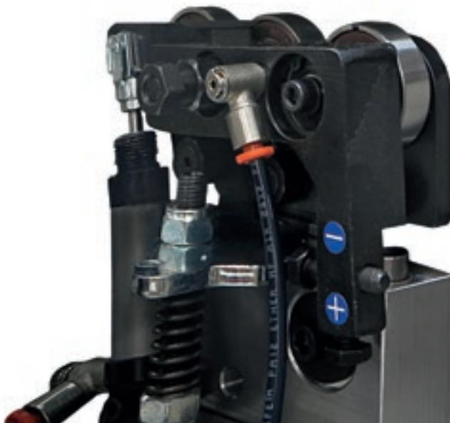
Le **Groupe racleur de colle** sert à éliminer les excès de colle dans la partie supérieure et inférieure du panneau, il s'agit du seul groupe présent sur le marché à être muni de 4 cylindres pneumatiques pour une haute qualité de finition.
