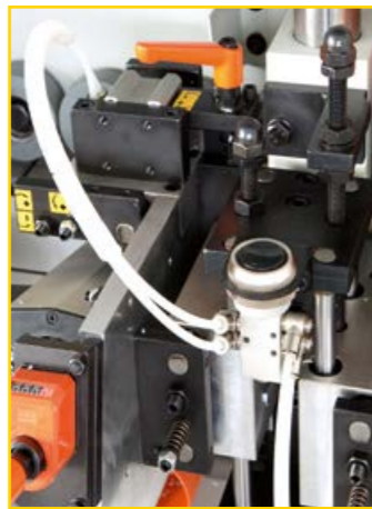
Sistema pneumatico "Spigolo / Raggio" per gruppo Refilatore
