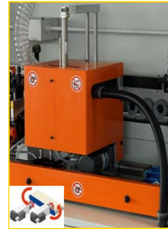
Gruppo arrotondatore PM 02 a 1 motore a 26.000 g/1' per la lavorazione degli spigoli.
