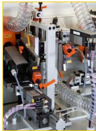
Gruppo Refilatore con sistema di posizionamento motorizzato DIGIT 02
