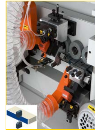
Gruppo raschiatore con nebulizzatore di liquido anti-adensivo
