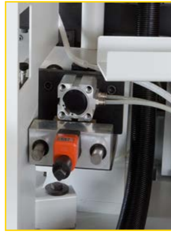
Guida d'introduzione con sistema di posizionamento pneumatico PN 02
