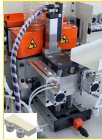
Gruppo rettifica con Digit 1 a tempo con 2 motori HF a 12.000 g/1'
