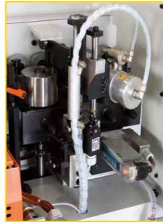
Gruppo traversa con sistema di posizionamento motorizzato DIGIT 01
