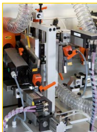
Gruppo spigolatore con Digit 2 HF 12.000 g/1' Inclinabile da 0° a 25°
