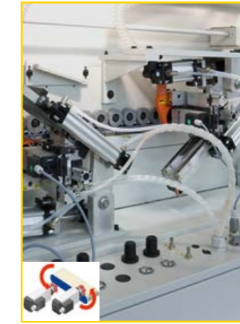
Gruppo arrotondatore ARP 01 PN 02 a 2 motori HF a 12.000 g/1' per la lavorazione degli spigoli.
