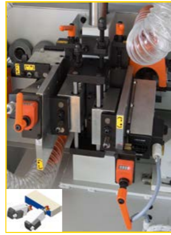
Gruppo refilatore HF 12.000 g/1' inclinato a 15°
