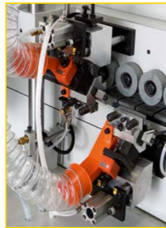
Sistema pneumatico per l'esclusione / inserimento del gruppo Raschiabordo MR
