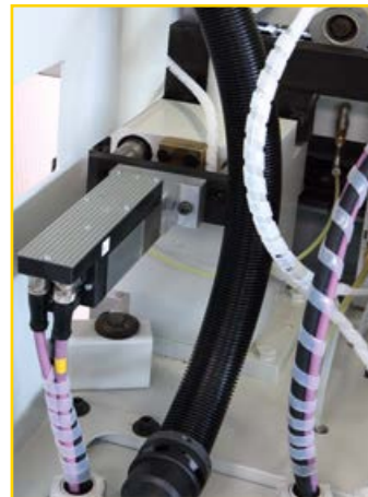
Guida d'introduzione con sistema di posizionamento motorizzato DIGIT O1
