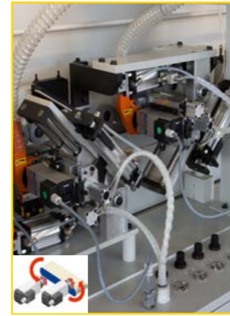
Gruppo arrotondatore ARP 02 PN 02 a 2 motori HF a 12.000 g/1' per la lavorazione degli spigoli.
