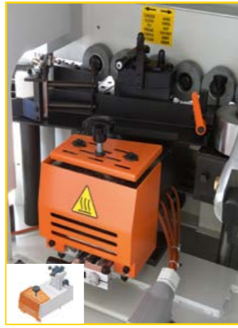
Vasca colla da lt. 2; tempo di riscaldamento di 5-6 min.
