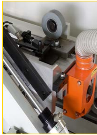
Sistema pneumatico per l'inclinazione del gruppo Intestatore, dal pannello di comando
