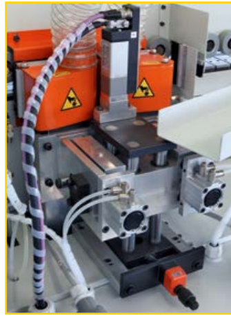
Sistema di auto-centraggio verticale motorizzato DIGIT 01 del gruppo Rettifica
