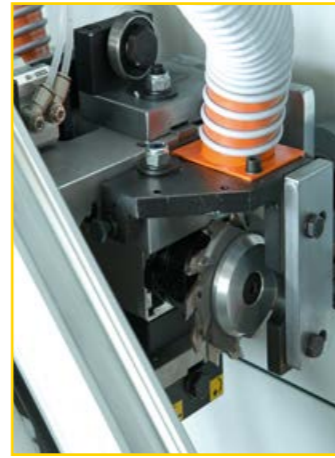
Sistema pneumatico "Dritto / Raggio" per gruppo Intestatore
