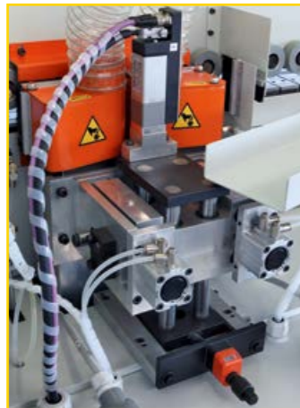
Sistema di auto-centraggio verticale motorizzato DIGIT O1 del gruppo Rettifica
