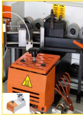
Vasca colla da lt. 3; tempo di riscaldamento di 5-6 min.
