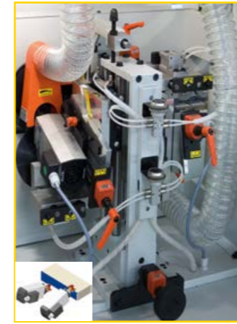
Gruppo spigolatore con PN 02 HF 12.000 g/1' Inclinabile da 0° a 25°
