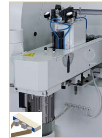
Gruppo levigatore a 3.000 g/1' con tampone automatico.
