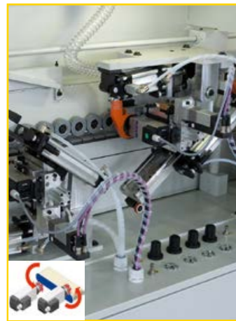
Gruppo arrotondatore ARP 01 Digit 2 a 2 motori HF a 12.000 g/1' per la lavorazione degli spigoli.
