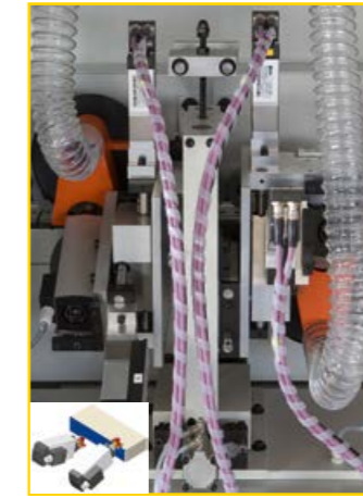
Gruppo spigolatore con Digit 4 HF 12.000 g/1' Inclinato a 15°
