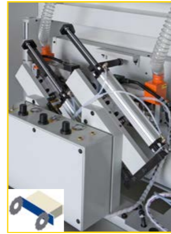
Gruppo intestatore verticale 2 motori a 12.000 g/1', inclinabile da 0° a 15°
