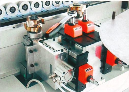
Guida di introduzione pannelli a spostamento elettropneumatico sincronizzata con l'accensione del gruppo toupie in entrata (opzionale sulla versione "Standard")
