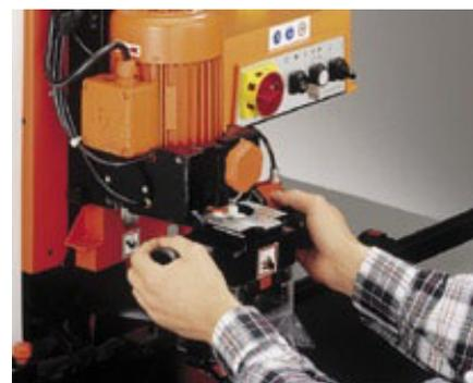
Der bestückte Bohrkopf, ebenfalls farblich gekennzeichnet, wird eingesetzt und mittels Spanngriff werkzeuglos befestigt.
