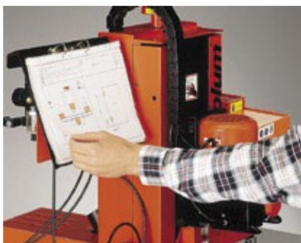
Im Rüstplan wird jeder Arbeitsschritt systematisch aufgezeigt und farblich gekennzeichnet.
