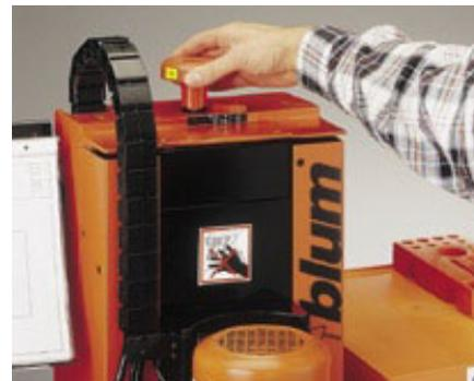
Mit dem farblich markierten Drehgriff (Revolveranschlag) können Bohrtiefen auf fixe Positionen voreingestellt werden.
