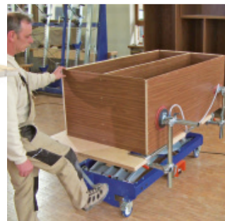
Lochplatte zum Pressen und Montieren nutzbar
