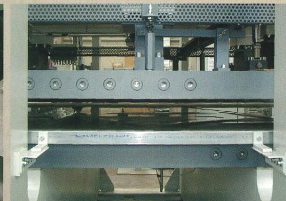
**MASSIVE STAHLHEIZPLATTEN** mit Druck-Verteilstücken
