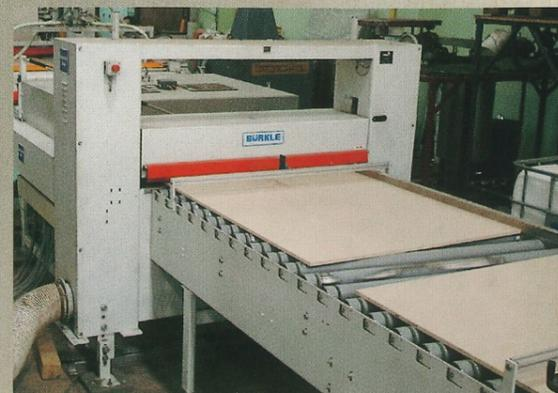
**QUERBÜRSTMASCHINE** für optimale Entstaubung
