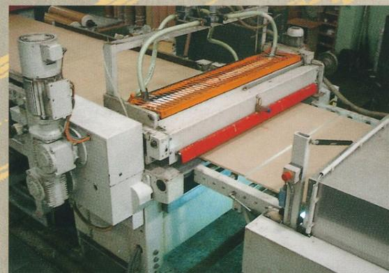
**LEIMAUFTRAGMASCHINE** für gleichmäßigen Leimauftrag
