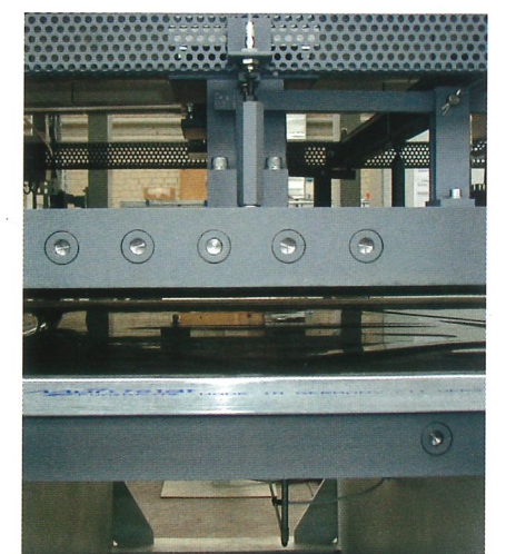
Massive Stahlheizplatten mit Druck-Verteilstücken Solid steel heating platens with pressure distributing pieces
