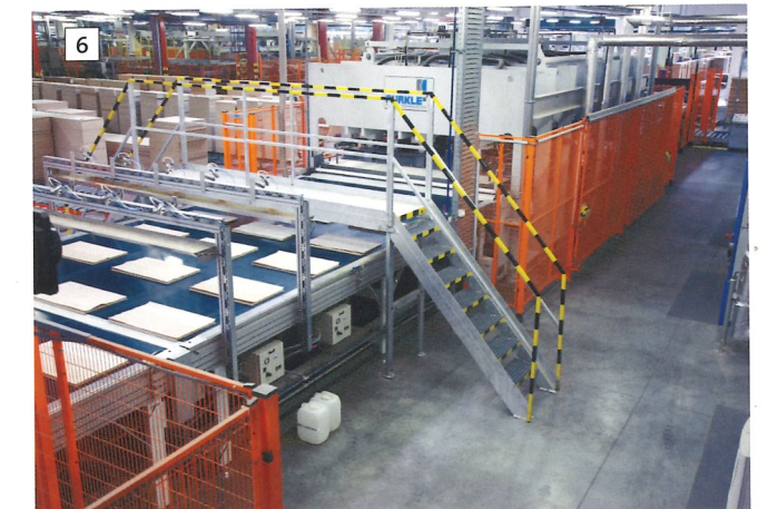
6 Kurztakt-Durchlaufpresse mit Beschickband und Befeuchtungseinrichtung Short-cycle throughfeed press with loading belt and humidifier
