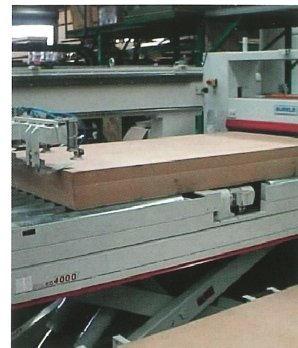
Einschubvorrichtung mit hydraulischem Scherenhubtisch zum taktweisen Beschicken der Anlage Infeed device with a hydraulic scissor lift table for the stepwise loading of the line
