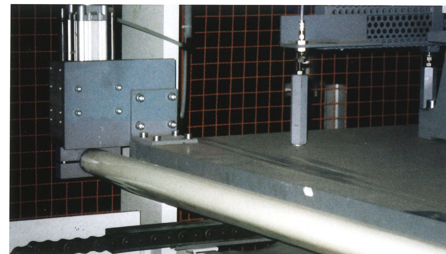
Abdrückeinrichtung zum Ablösen der Werkstücke, die nach dem Öffnen der Presse an der oberen Zulagefolie haften Pushing device to remove the boards which stick to the top foil when opening the press
