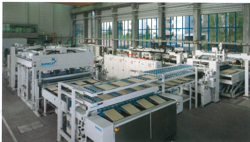
Winkelanlage zum Furnieren von bis zu 5 Teilen pro Legereihe Line of angular design for the veneering of up to 5 boards per laid-up row
