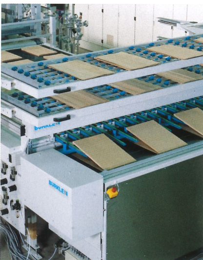
Automatisches Ablegen der belemten Trägerplatten Automatic depositing of the glued substrates
