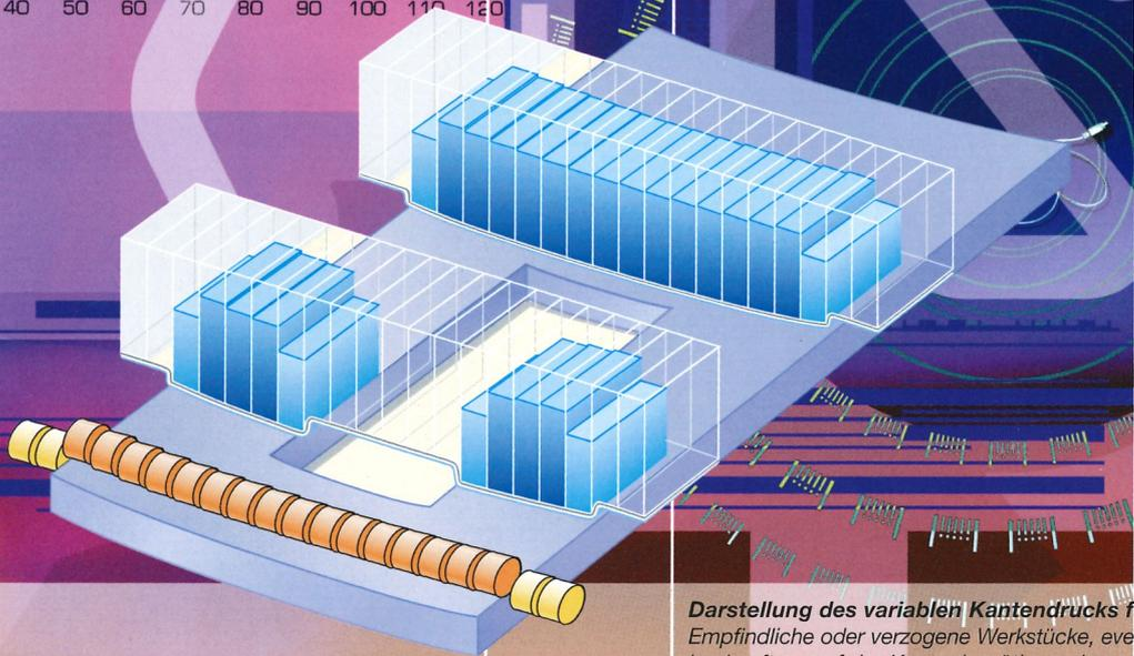
**Darstellung des variablen Kantendrucks für 50 oder 25 mm Segmente**
