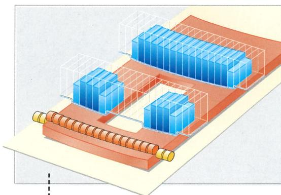
CPS II-Elektronik-Schleifschuh mit 25 mm Segmentbreite und programmierbarem, variablen Kantendruck
