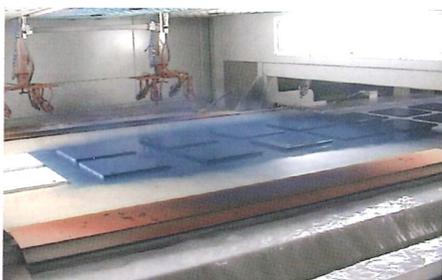
Für den jeweils perfekten Lackzwischenleif lassen sich die Vielzahl der verschiedenen Parameter wie Vorschubgeschwindigkeit, Schleifbandgeschwindigkeit, Flächen- und Kantendruck des CPS II-Elektronik-Schleifschuhs, exaktes Ein- und Aussetzen auf den vorderen und hinteren Werkstückkanten, Bandausblasvorrichtung und Vakuumtisch schnell und einfach in der Terminalsteuerung abspeichern und sind dann sekundenschnell wieder abrufbereit – auch bei Stückzahl eins.
