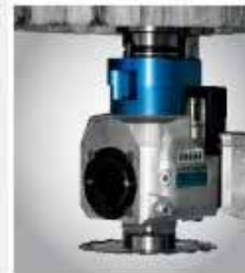
Trasforma il tuo centro di lavoro in una macchina a 4/5 assi grazie a "Disk", aggregato frese/lama ad inclinazione variabile gestita da CN.
