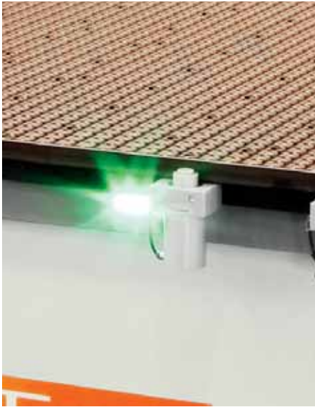
Luminous indicators to regulate access to the loading/unloading area Leuchtmelder für Freigabe Zugang im Aufgabe-/Abladebereich Indicateurs lumineux pour régulariser l'accès à la zone de chargement/déchargement
