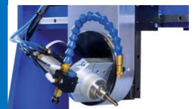
Schwenkkopf (5-Achs-Bearbeitung), BZT PFU Swivel head (5-axis machining), BZT PFU
