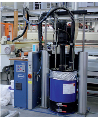
Fassschmelzer zum Aufschmelzen des Klebers Drum melting unit to melt the glue
