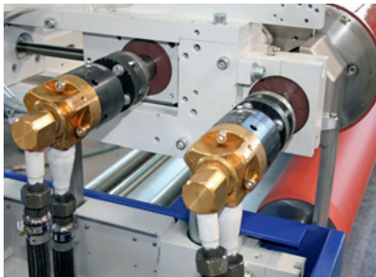
Thermoölzuführung über Drehanschluss Rotary connection for heating of the rollers
