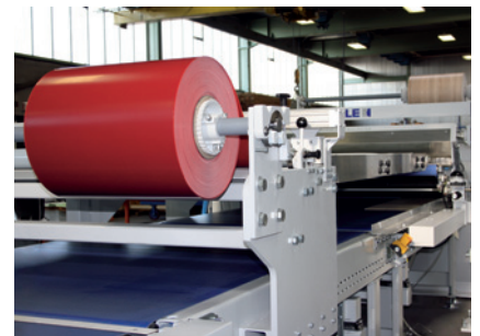
Abwickelstation mit Schneideeinrichtung. Uncoiling station with cutting device
