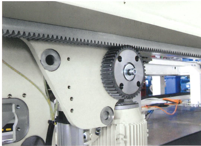
CARRO AZIONATO DA SISTEMA A PIGNONE E CREMAGLIERA Consente il raggiungimento delle massime velocità disponibili ed una estrema fluidità di scorrimento del carro-lame.
