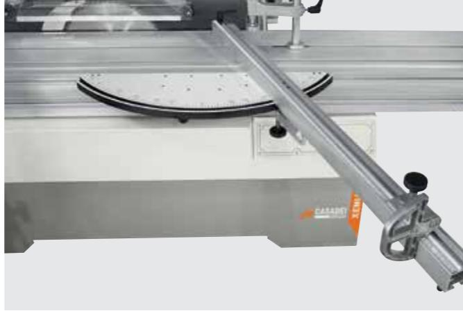
Guida per tagli angolari con compensazione automatica della posizione della battuta rispetto alla lama. Ad ogni variazione di angolo la distanza della battuta rispetto alla lama rimane sempre costante: ciò permette una messa a punto veloce e fa risparmiare tagli di prova.
