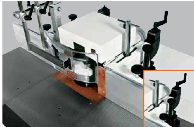
Guida toupie con movimentazione a manovella, con regolazione lineare in continuo per la traslazione dell'intera guida e per la sola guida d'ingresso. Gli spostamenti sono visualizzati da numeratori digitali meccanici. Le maniglie laterali agevolano le operazioni di asporto dal piano di lavoro.
