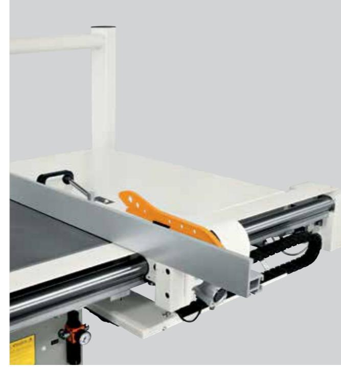
Guida parallela motorizzata "Versione A"
