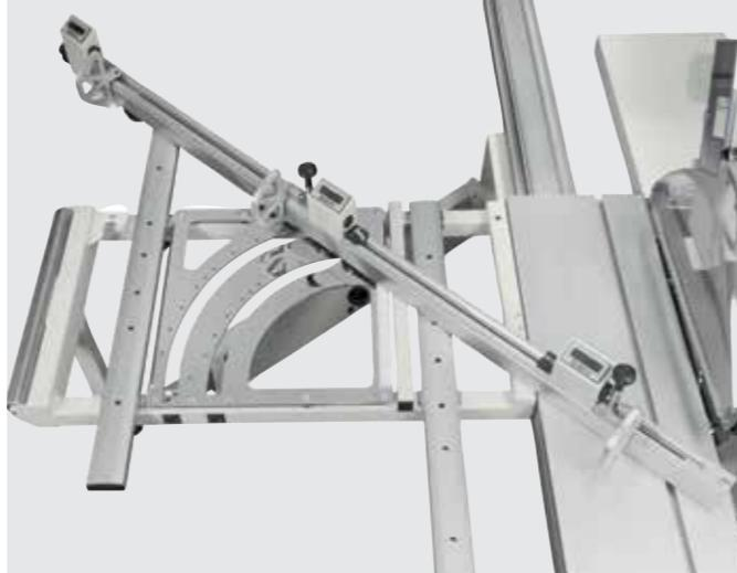
Telaio a squadre con dispositivo di compensazione delle battute
