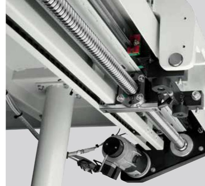
Guida parallela motorizzata "Versione AX"
