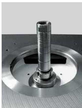
Albero intercambiabile con attacco MK4, per l'utilizzo di utensili con diametro del foro differente grazie alla possibilità di sostituire l'albero portafresce rapidamente.
