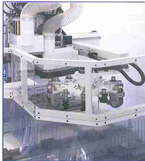
Cambio utensile a bordo testa fino a 20 posizioni Tool change up to 20 positions together with routing heads.
