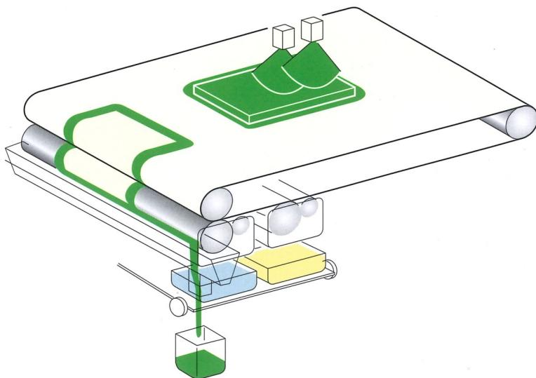
Il sistema di trasporto pezzi a nastro CFB permette il recupero della vernice e aderisce perfettamente al pezzo da verniciare lasciando la controfaccia perfettamente pulita.
