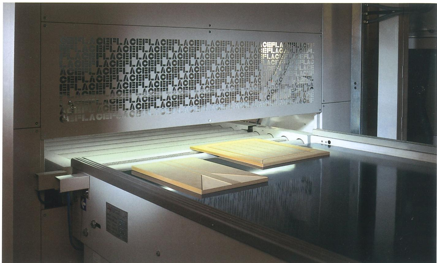
Il posizionamento dei pezzi è gestito in automatico dal controllo elettronico che rileva la composizione della carica in ingresso tramite barre di lettura ad alta precisione (da 120, 208 o 512 fotodiodi) e genera automaticamente le migliori traiettorie di spruzzatura, eventualmente anche integrando le informazioni acquisite coi disegni di sagome preparate con un programma CAD.
