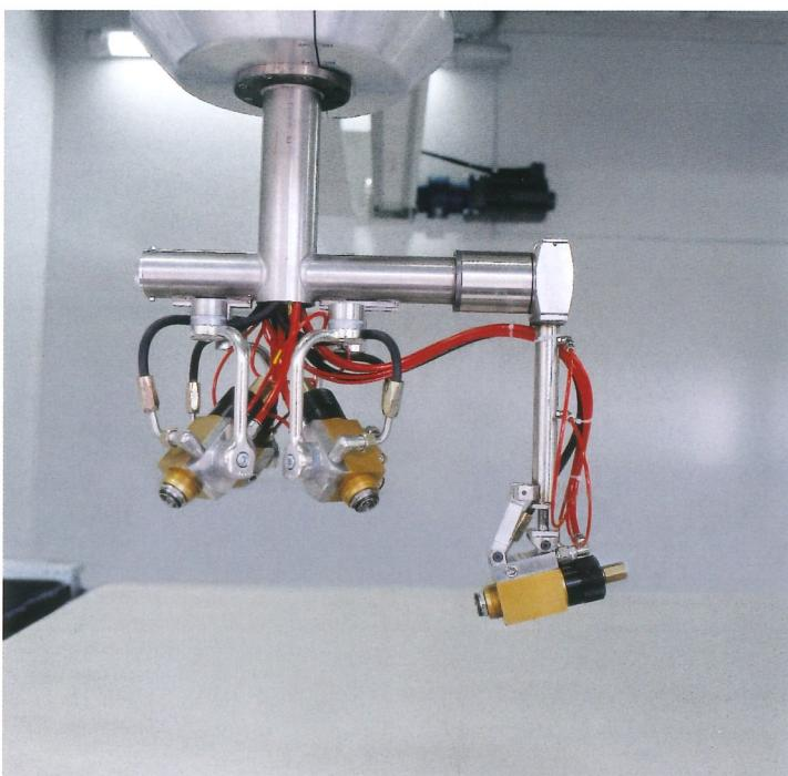
Il cambio rapido del braccio portapistole, fornibile a richiesta, facilita le operazioni di cambio prodotto quando è necessario utilizzare un diverso tipo di pistole. Smontaggio braccio con circuiti prodotto in pressione.
