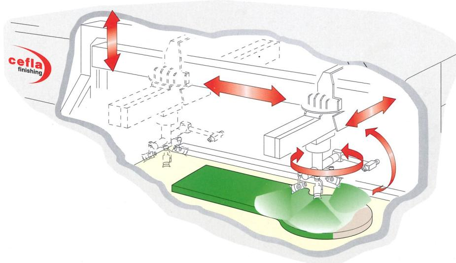
La velocità (fino a 150 mt/min.) di scorrimento degli assi controllati X e Y è ottenuta con l'impiego di guide particolari, garantite per oltre 10000 ore di funzionamento.
