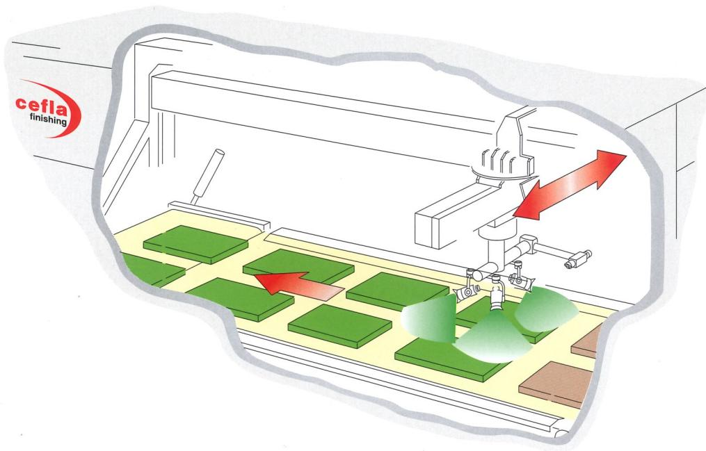
La flessibilità di Spraybotic consente di passare dal funzionamento come Robot per verniciare pezzi di forma complessa, al funzionamento oscillante che permette l'applicazione della vernice con movimentazione trasporto in continuo.
