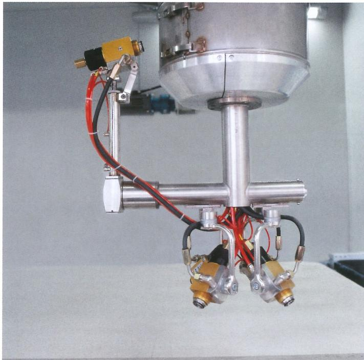
La spruzzatura del piano con 4 pistole consente l'ottenimento di un'alta produttività sia nel funzionamento da robot che in quello oscillante e contribuisce a raggiungere un'ottima distensione del prodotto sulle superfici da applicare. La quinta pistola dedicata alla verniciatura dei bordi ne consente la perfetta esecuzione.
