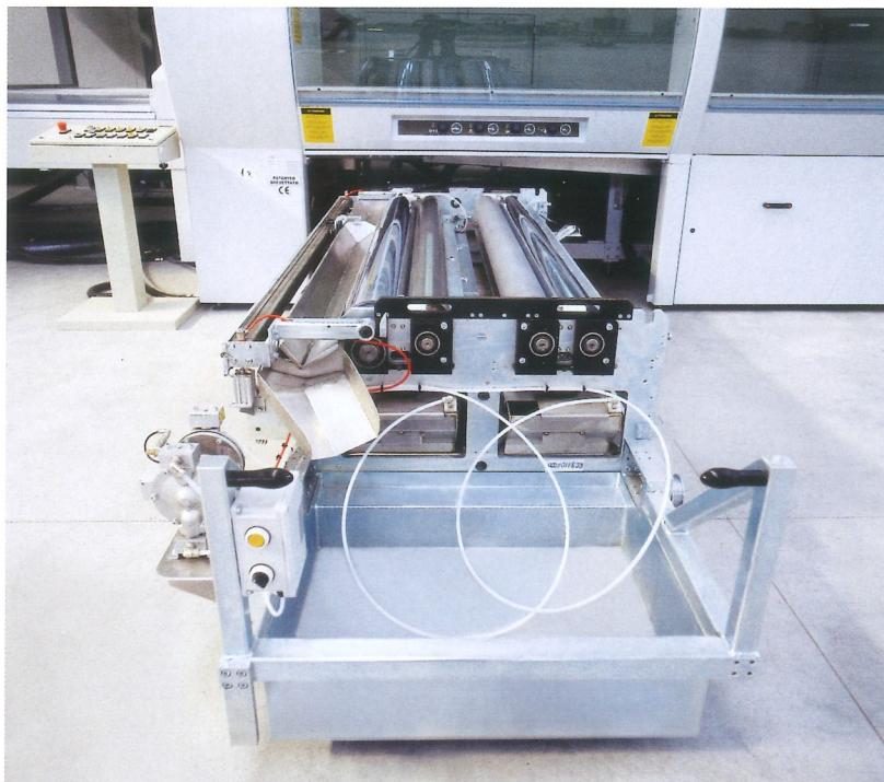
Sistema di recupero vernice (brevettato) e di pulizia del tappeto ad estrazione longitudinale. Il doppio rullo reverse autopulente abbatte il consumo di solvente ed il tempo di pulizia.
