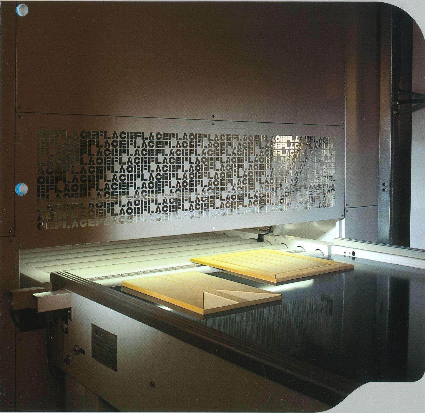
La spruzzatura del piano con 4 pistole consente l'ottenimento di una alta produttività sia nel funzionamento da robot che in quello oscillante.
