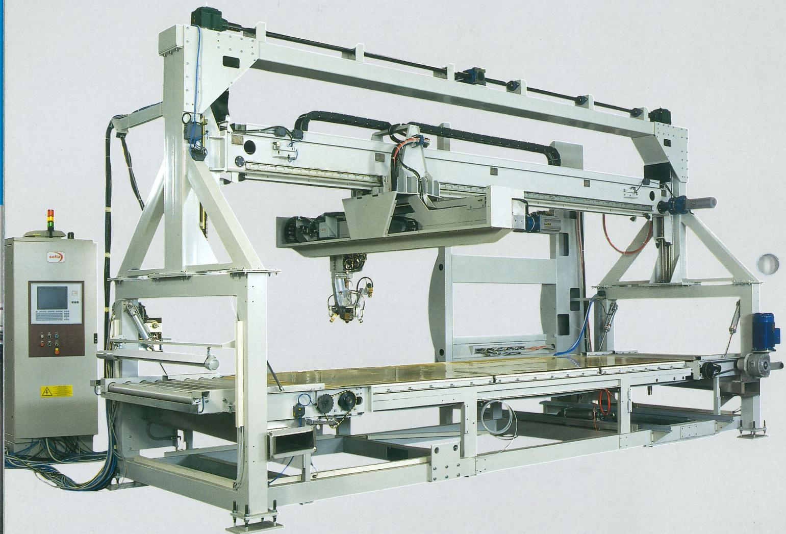
La struttura meccanica di eccezionale robustezza consente l'esecuzione di movimenti precisi e veloci (150 mt/min) senza dare luogo a fastidiose vibrazioni.
