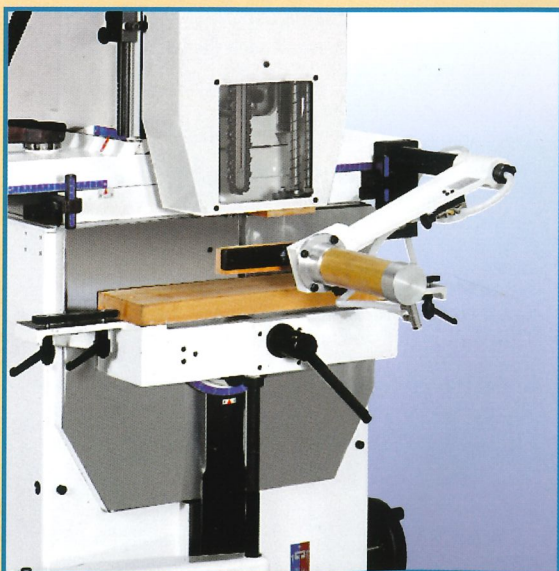
Pressore frontale pneumatico (opzionale). Pressueur frontal pneumatique (sur demande). Pneumatic front clamp (optional). Front-Druckluftzylinder (auf Anfrage).
