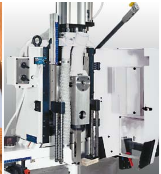
Particolare dell'unità porta-bedano. Detail de l'unité porte-bedane. View of chisel-holder unit. Detailansicht des Lochbeitelaggregates. Especifico de la unidad porta-herramienta bedano cuadro
