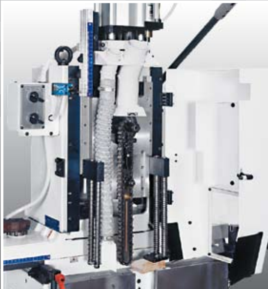
Particolare del gruppo porta catena. Detail de l'ensemble porte-chaîne. Front view of chain-holder unit. Detailansicht des Kettenaggregates. Especifico del grupo porta-cadena
