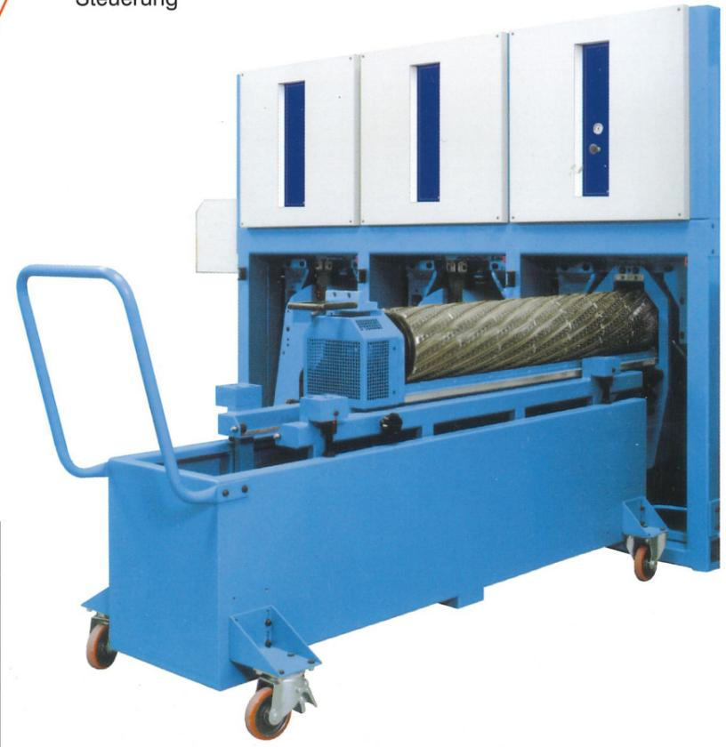
Jedes W250 Aggregat, von unten oder von oben, sowie jede Ersatzmesserwelle verfügt über einen Servicewagen zum einfachen Auswechseln und sicheren Transport.
