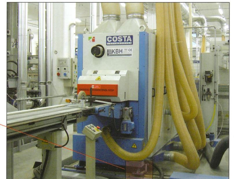
Eine gleichmässige Vorschubgeschwindigkeit ist unumgänglich um eine konstante Spanabnahme und ein perfektes Oberflächenfinish (ohne Dickentoleranzen oder Quermarkierungen) zu erzielen.
