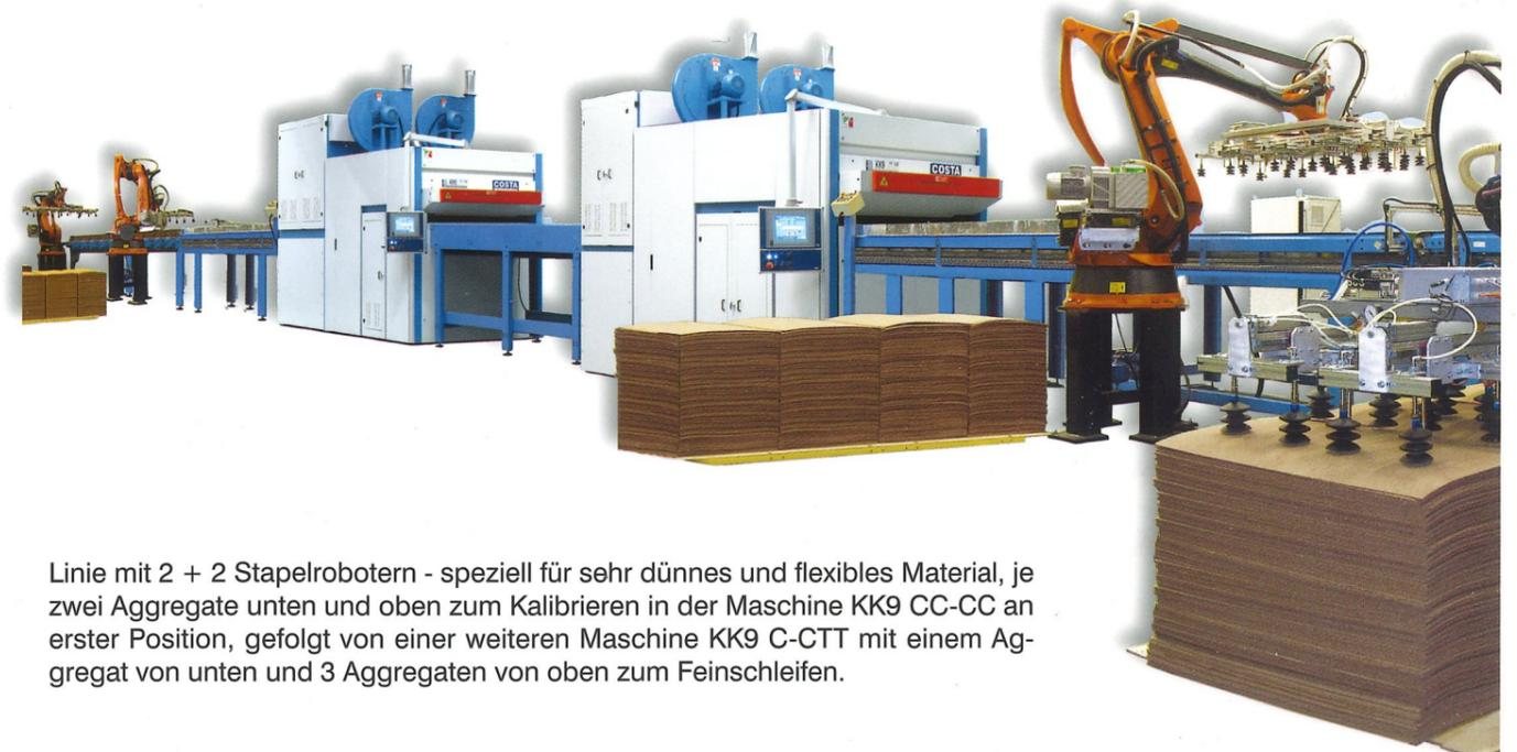
Linie mit 2 + 2 Stapelrobotern - speziell für sehr dünnes und flexibles Material, je
