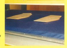
Nach Abbinden des Leimes wird die Presse geöffnet und die formfurnierten Werkstücke aus der Presse entnommen. C-S CONTURA geht sofort wieder in die Ausgangsposition zurück und ist für den nächsten Pressvorgang bereit.
