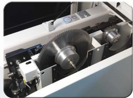
Detalle cambio neumático de disco e incisor
