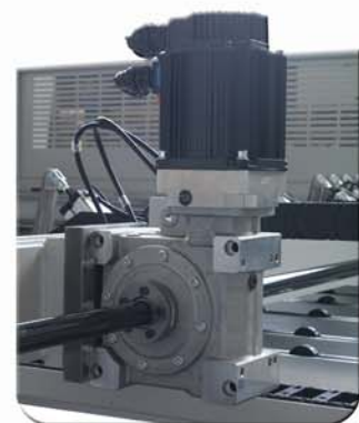
El movimiento del empujador se efectúa mediante motor Brushless, y un reductor de precisión.
