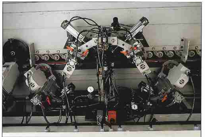
RIBETADOR DE FORMAS (SUPERIOR E INFERIOR). PROFIL TRIMMING UNIT (TOP & BOTTOM). AFFLEURAGE DES FORMES (SUPÉRIEURES ET INFÉRIURES). KOPIERAGGREGAT FÜR OBERE UND UNTERE PROFIL.
