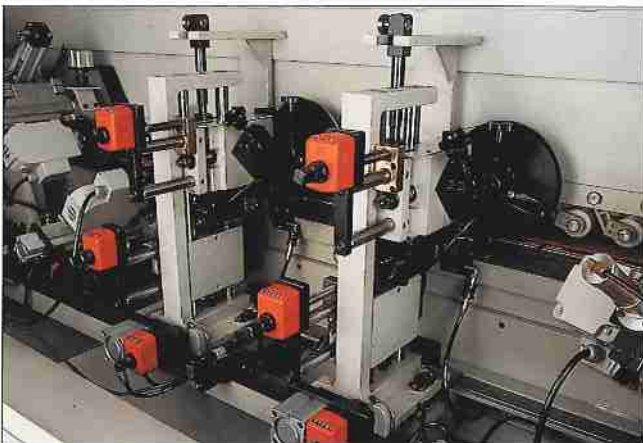
RASCADOR PARA FORMAS, RECTAS Y RADIOS. EDGE SCRAPING UNIT, STRAIGHT AND RADIUS. GROUPE DE RECLAGE, DROIT ET RAYON 3 MM. ZIEHKLINGENAGGREGAT, BÜNDIG UND MIT RADIEN.
