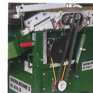
Ausgereifte Technik: Messerschwinge- und Vorschubtrieb.
