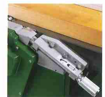
Mittels Drehgriff läßt sich die Spanabnahme ganz genau einstellen.
