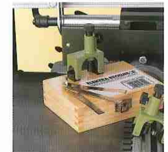
4 Wesentliche Erleichterung beim Einstellen der Hobelmesser: Das Hobelmessereinstellgerät garantiert optimale Wiederholgenauigkeit.
