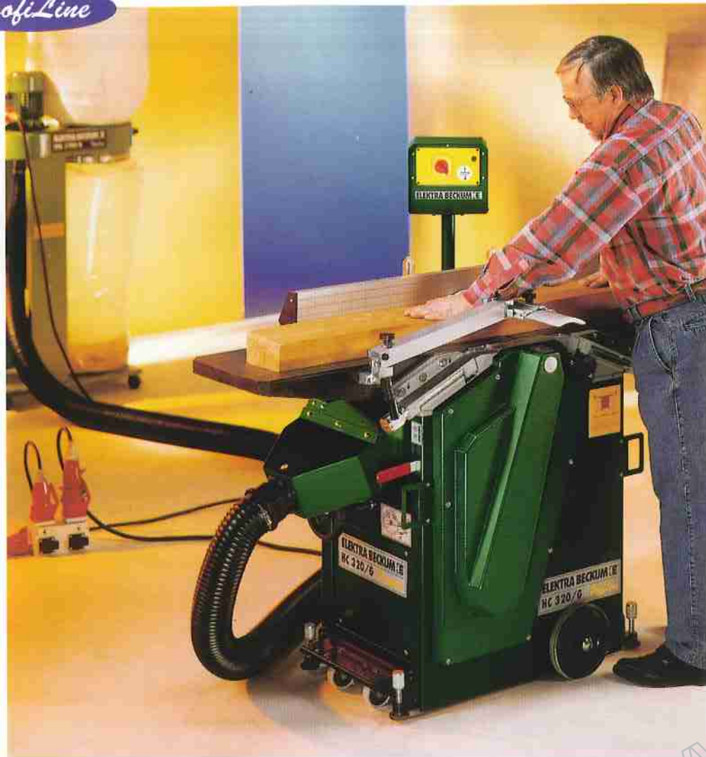
Der Abrichtanschlag mit seiner Länge von 1100 mm, ist bis 45° schwenkbar.
