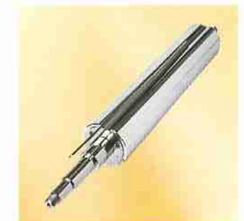
3 Bei der Fiehkrafthobelmesserwelle zentrieren sich die Hobelmesser auf 1/100stel automatisch. Zusätzliches Einstellen ist nicht erforderlich.
