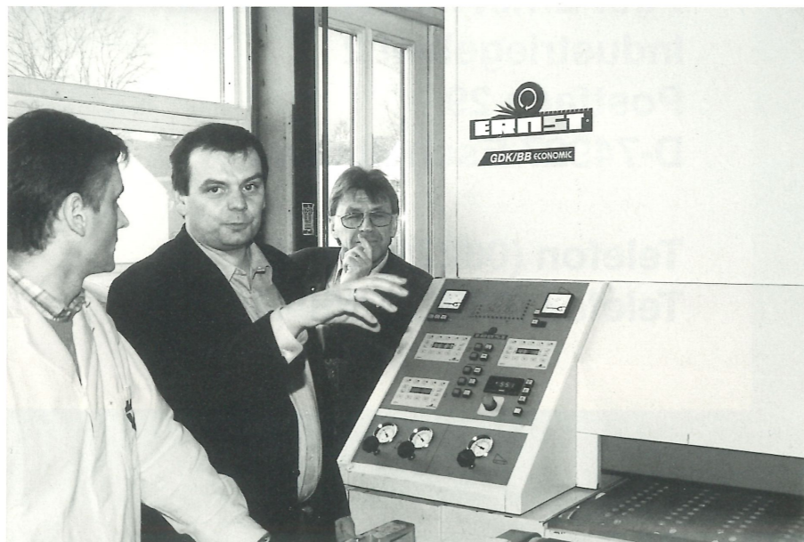
Abb. 1: Eine einwandfreie Lackierfläche wird zunächst einmal durch einen hervorragenden Holzschliff bzw. nach der Grundierung durch einen einwandfreien Lackschliff erreicht. Firmenchef Mitsch, im Bild Mitte, erklärt es hier an der „Ernst Typ 520-2 Duplex“
