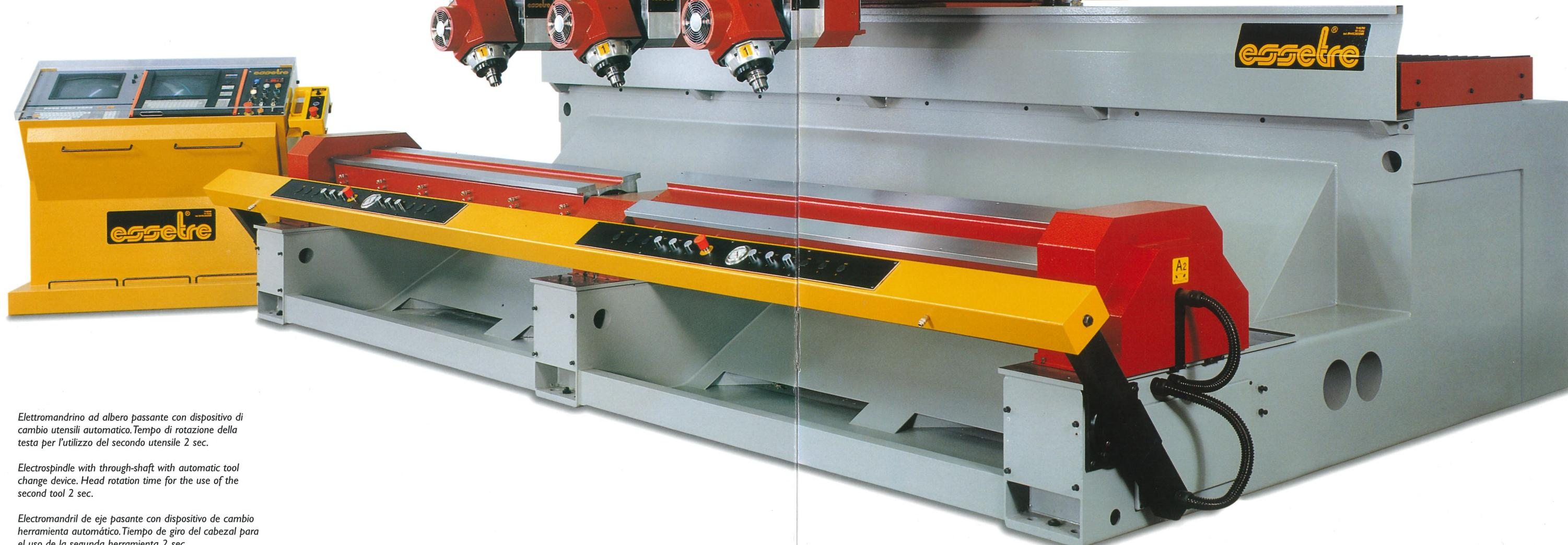
Elettromandrino ad albero passante con dispositivo di cambio utensili automatico. Tempo di rotazione della testa per l'utilizzo del secondo utensile 2 sec.
