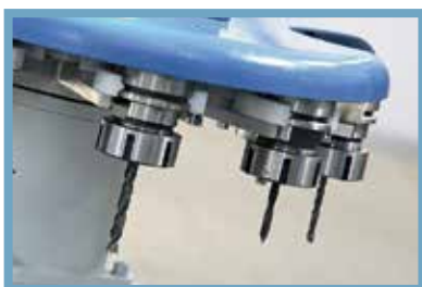
Magazynek talerzowy na 14 narzędzi 14-tool disk magazine
