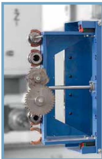
Magazynek listwowy na 6 narzędzi, mocowany na kolumnie bramy 6-tool slatted magazine mounted on the gantry column
