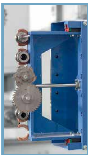
Magazynek listwowy na 6 narzędzi, mocowany na kolumnie bramy 6-tool slatted magazine mounted on the gantry column
