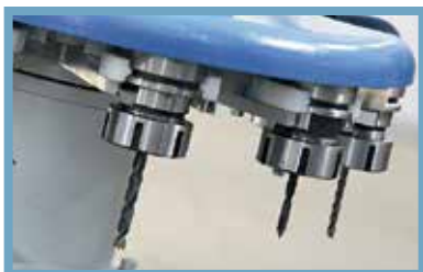
Magazynek talerzowy na 14 narzędzi 14-tool disk magazine
