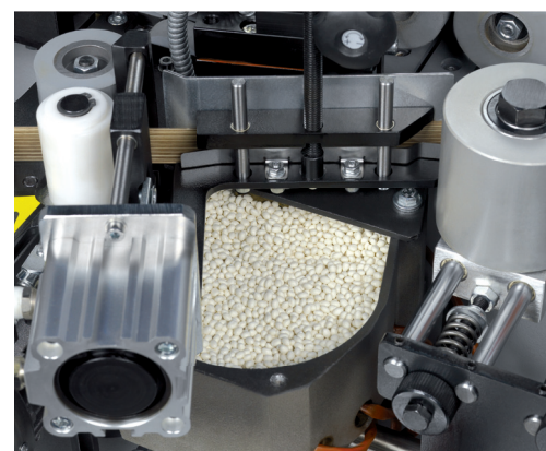
Pokryty teflonem pojemnik o pojemności 1,2 kg dla topliwego kleju granulowanego. Precyzyjne dozowanie kleju za pomocą regulowanego walca nanoszącego klej.
