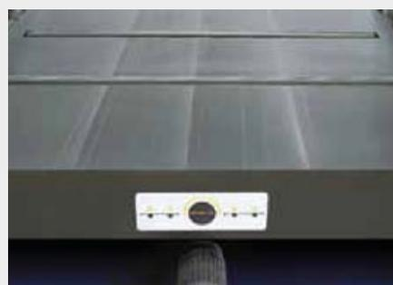
Comando del piano dello spessore con precisione al decimo di millimetro
