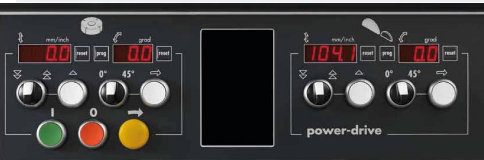
Il pacchetto di dotazione "Power-Drive" consente di regolare l'altezza e gli angoli della sega circolare e dell'albero toupie comodamente e con una precisione al decimo di millimetro. Per una regolazione fine, sono disponibili anche qui un pulsante e chiari display a LED che visualizzano il valore effettivo attuale.
