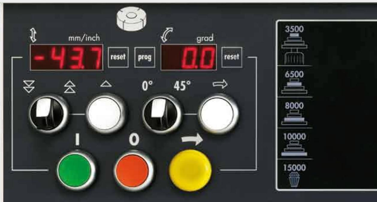
Il comando completamente elettronico "Power-Drive" offre il massimo dell'esattezza nella regolazione e nelle ripetizioni. Mediante una manopola, si può eseguire la regolazione in altezza e angolare della lama, la regolazione fine si esegue con precisione al decimo di millimetri mediante un pulsante. Le cifre LED mostrano il valore effettivo direttamente dal pannello di comando e in tempo reale.
