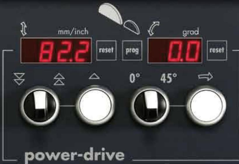
Anche l'altezza e l'angolo della lama possono essere regolati al decimo di millimetro. Per una regolazione fine, sono disponibili anche qui pulsanti e chiari display a LED per la visualizzazione del valore reale corrente.
