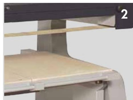
**1** Il piano di levigatura della levigratrice a nastro Felder ha una parte centrale rimovibile. Ciò consente la levigatura di parti di telaio e di cassetti.
