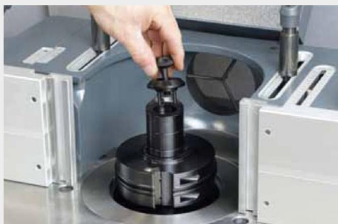
Per il cambio dell'albero toupie, il collaudato sistema di cambio rapido dell'albero toupie assicura la massima produttività. Alberi toupie con diversi diametri e utensili premontati per eseguire lavori di fresatura in serie, possono essere montati in pochi secondi.
