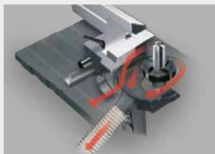
Aspirazione doppia del truciolo dalla guida toupie e dal contenitore di raccolta trucioli sotto il piano di fresatura per una maggiore pulizia della macchina e migliori risultati della lavorazione.
