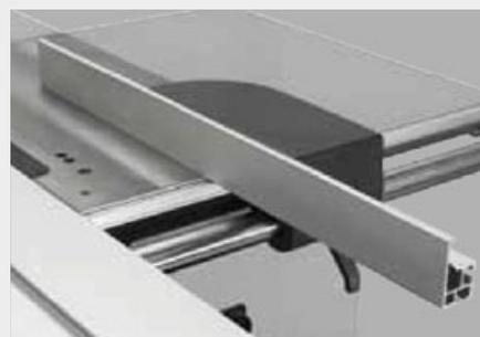
È possibile spostare all'indietro la riga in alluminio della sega circolare per le operazioni di rimozione o per una migliore alimentazione dei pezzi.
