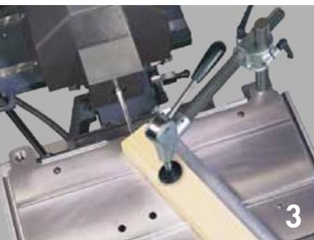
**1** La mortasatura di fori quadrati o rettangolari può essere effettuata con l'unità supplementare per mortasature. Per le connessioni a tenoni e mortase, non è più necessario arrotondare i tenoni, poiché la mortasa è realizzata „ad angolo“. Questa caratteristica consente di risparmiare lunghi interventi manuali.
