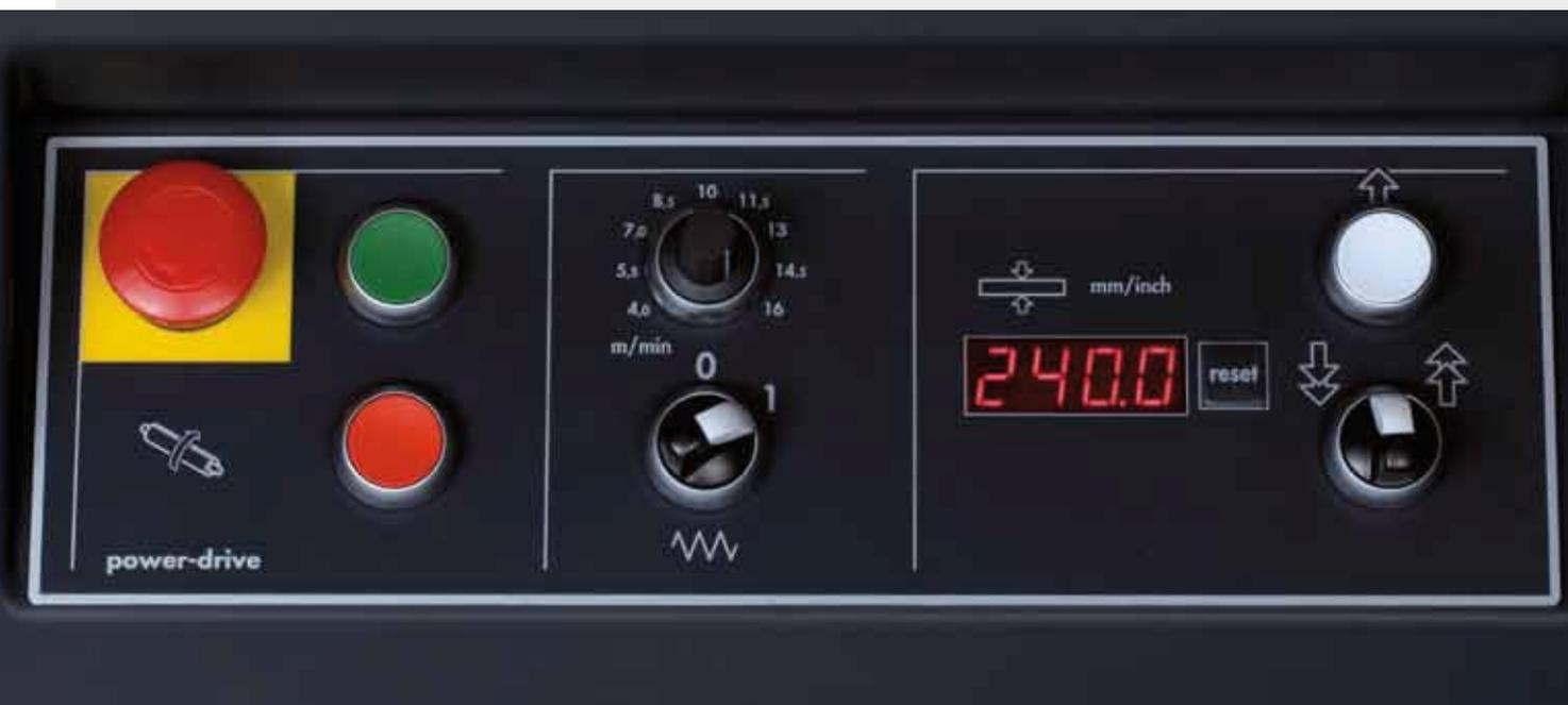
Il dispositivo di controllo del tavolo spessore „Power-Drive“, completamente elettrico, consente regolazione precisa e ripetizione esatta. Con una manopola, si può regolare rapidamente l'altezza del piano spessore, la regolazione fine avviene tramite pulsante. Sul display a LED integrato è possibile leggere il valore effettivo in modo semplice.
