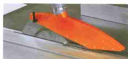
Sägehaube am Spaltkeil befestigt
