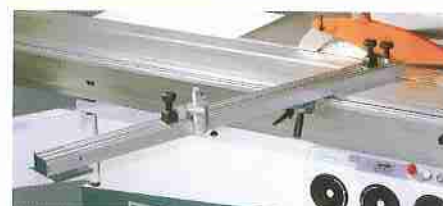
Gehrungsanschlag ohne Aufpreis im Grundlieferumfang
