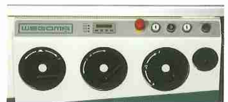
Bedienfront: Höheneinstellung, Winkeleinstellung, Verstellung Parallelanschlag
