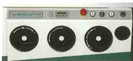
Bedienfront: Höheneinstellung, Winkeleinstellung, Verstellung Parallelanschlag
