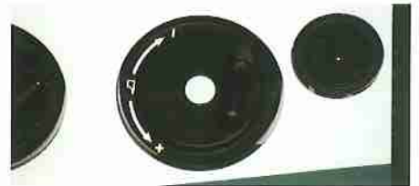
Verstellung Parallelanschlag mit Handrad und Handrad für Feinverstellung
