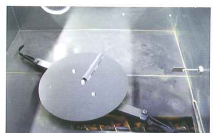
Robustes Rührwerk, Austragarme mit Federmechanismus, Schneckenverdrichtung
