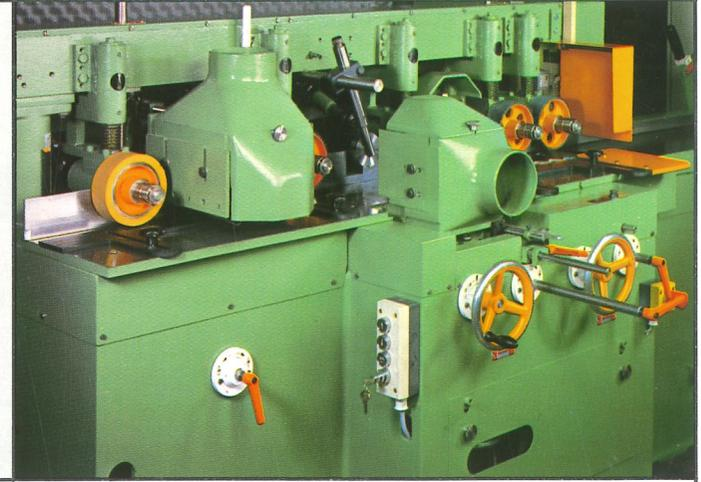
Arbeitsbreite 200 mm auch bei 180 mm Flugkreisdurchmesser
