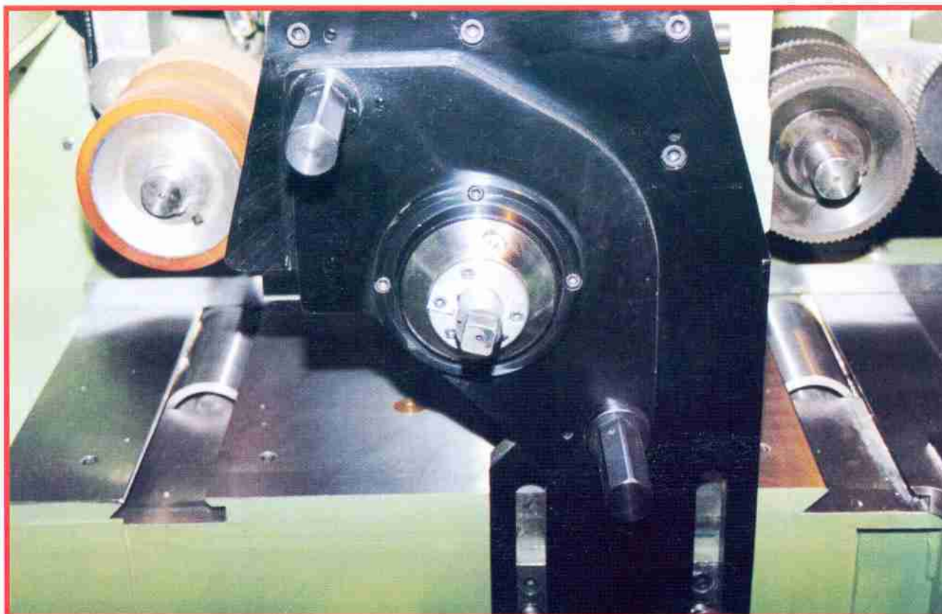
Pression pneumatique. Cylindres entraîneurs crantés. Cylindre entraîneur lisse dans la table de travail. Contre-paliers avec blocage automatique. Pneumatic pressure. Motorised serrated rollers. Motorised rollers in working table. Double supports with automatic clamping. Pneumatischer Druck. Gezahnte Vorschubwalzen und angetrieben Rollen im Tisch. Gegenlagern mit automatische Klemmung. Presion neumatica. Cilindro dentado de arrastre. Rodillos para la mesa de trabajo.
