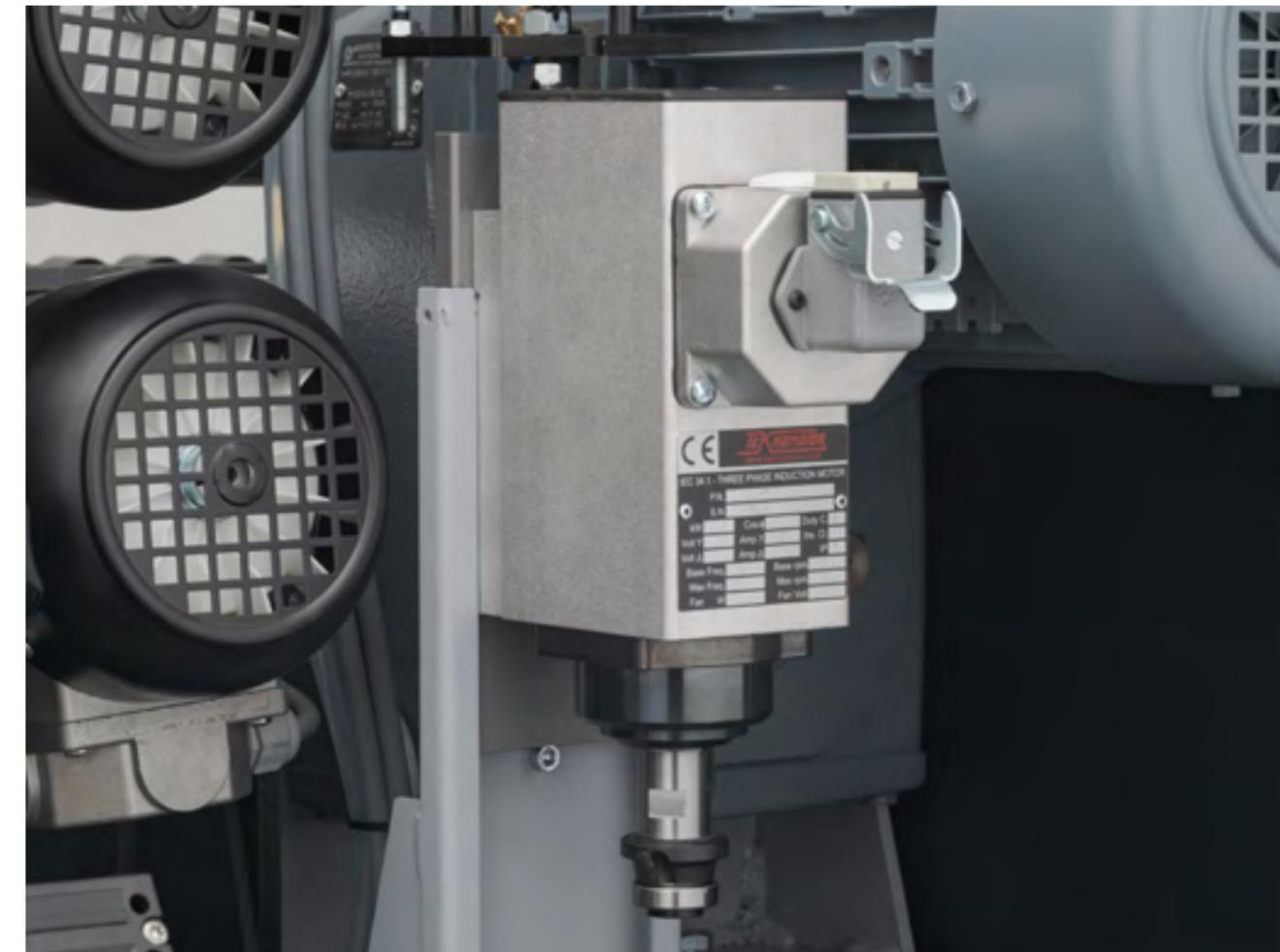
**Zusätzlicher Wechselmotor Eckenabrundfräse:** Mit dem voreingestellten Wechselmotor inkl. Werkzeugbestückung werden Rüstzeiten der Maschine bei Wechsel des Vorkopfradius reduziert. Mit Hilfe der Schnellwechsellvorüstung ist ein Wechseln des Motors in kürzester Zeit und ohne zusätzliche Einstellungen in der Maschine möglich.
