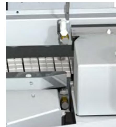
**Trennmittelsprüheinrichtung:** Vor der Bekantung wird durch das Sprühsystem das Trennmittel hauchdünn auf die Ober- und Unterseite der Werkstückrandbereiche gesprüht. Dadurch wird verhindert, dass sich austretender Klebstoff mit dem Werkstück verbindet. Gerade bei der regelmäßigen Verarbeitung von PUR Leim empfiehlt sich diese Option.
