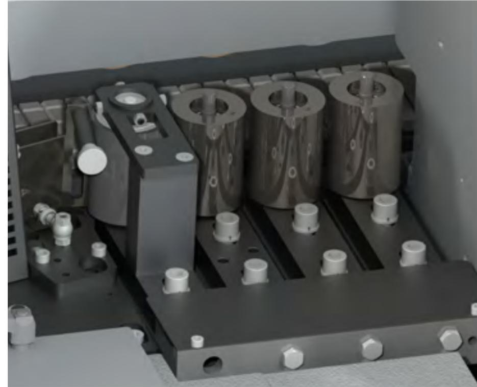
**Beheiztes Einlauflineal:** Mit dieser Option lassen Sie Plattenmaterialien vor der Verarbeitung erwärmen, so dass eine optionale Verarbeitungstemperatur erreicht werden kann. Gerade bei Temperaturschwankungen innerhalb der Werkstätten oder Außenlager der Werkstoffe zu empfehlen.
