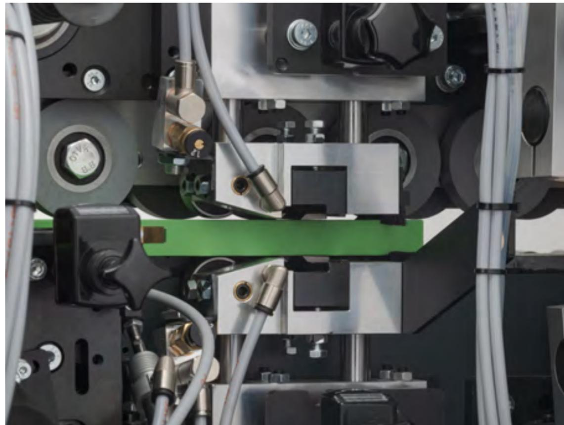
**Flächenziehklinge:** Dynamisch gelagerte Flächenziehklinge für höchstmögliche Fertigungsqualität sogar bei schwierigsten Materialien. Durch die breite Auflagefläche wird das Kantenmaterial präzise und vor allen Dingen schonend abgetastet und ermöglicht eine gleichbleibende Qualität und entfernt Klebereste und Kantenüberstände.
