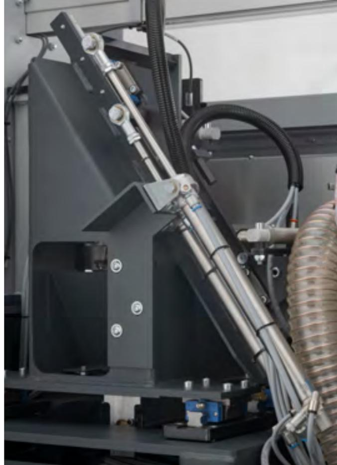
**Doppelmotorige Kappsägestation:** Die stabile Bauweise des doppelmotorigen Kappsägeaggregats mit Linearführungen ermöglicht das präzise Sägen der Werkstück Vorder- und/oder Hinterseite auch bei hohen Stückzahlen und kurzer Werkstückfolge. Wahlweise lassen sich die Kappsägen für Ihre Anwendung um 12,5° verstellen. Die Einstellung erfolgt über die Display-Steuerung einfach von der Maschinenvorderseite aus.
