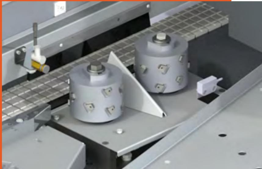
**8 mm Ausführung:** Die maximale Kantenstärke erhöht sich von 3 mm auf 8 mm. Durch stärkere Motoren verarbeiten Sie Echtholzanleimer und erhöhen so die Standzeit Ihrer Werkzeuge.
