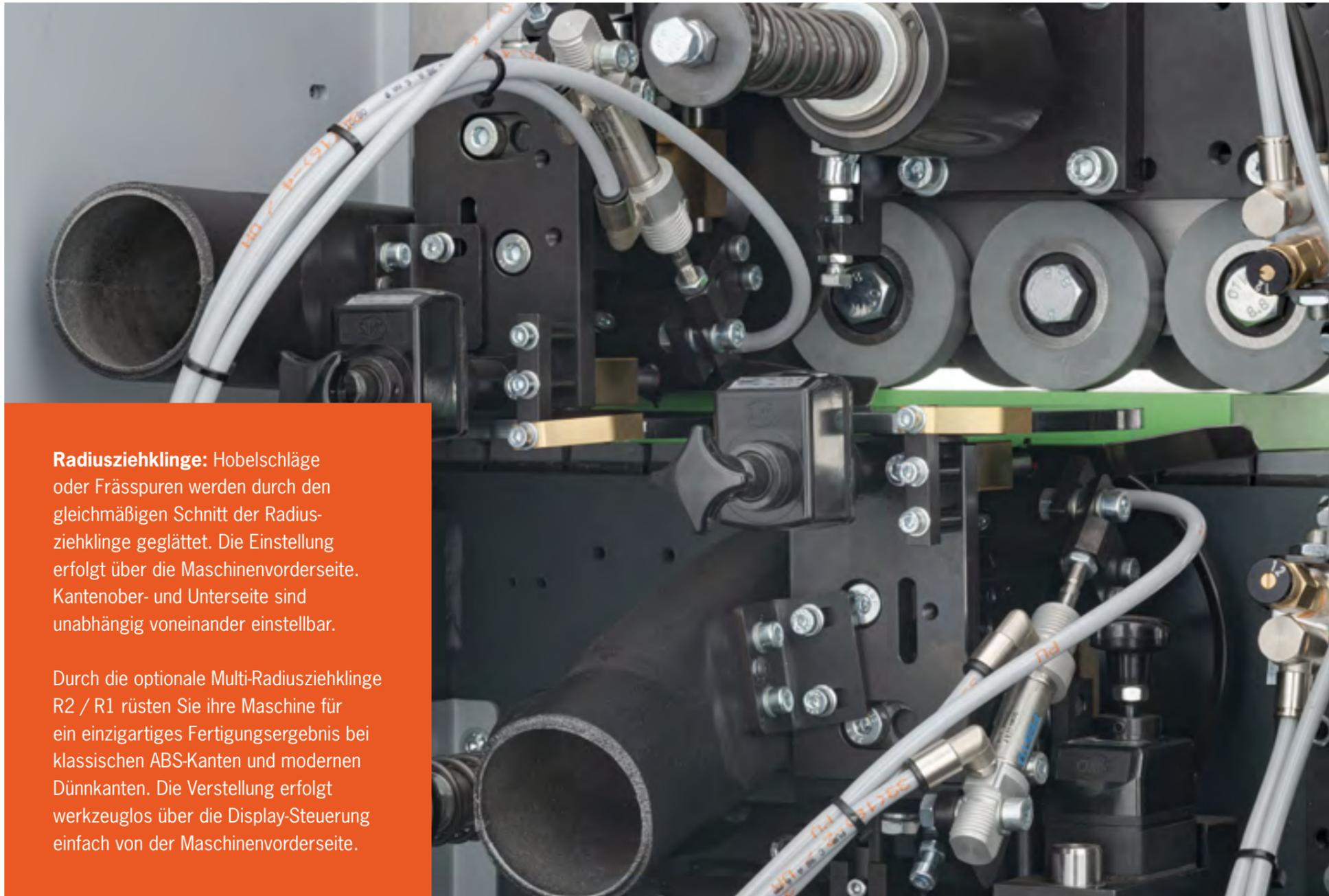
**Radiusziehklinge:** Hobelschläge oder Frässpuren werden durch den gleichmäßigen Schnitt der Radiusziehklinge geglättet. Die Einstellung erfolgt über die Maschinenvorderseite. Kantenober- und Unterseite sind unabhängig voneinander einstellbar.
