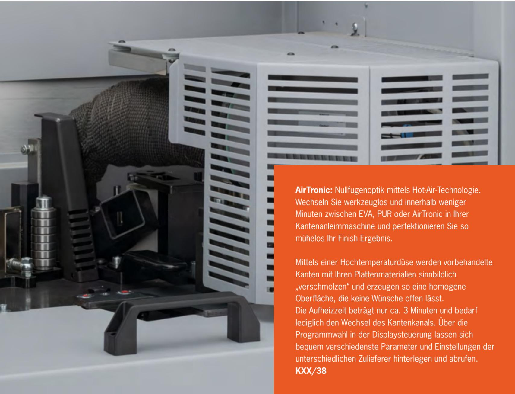
**AirTronic:** Nullfugenoptik mittels Hot-Air-Technologie. Wechseln Sie werkzeuglos und innerhalb weniger Minuten zwischen EVA, PUR oder AirTronic in Ihrer Kantenleimmaschine und perfektionieren Sie so mühelos Ihr Finish Ergebnis.
