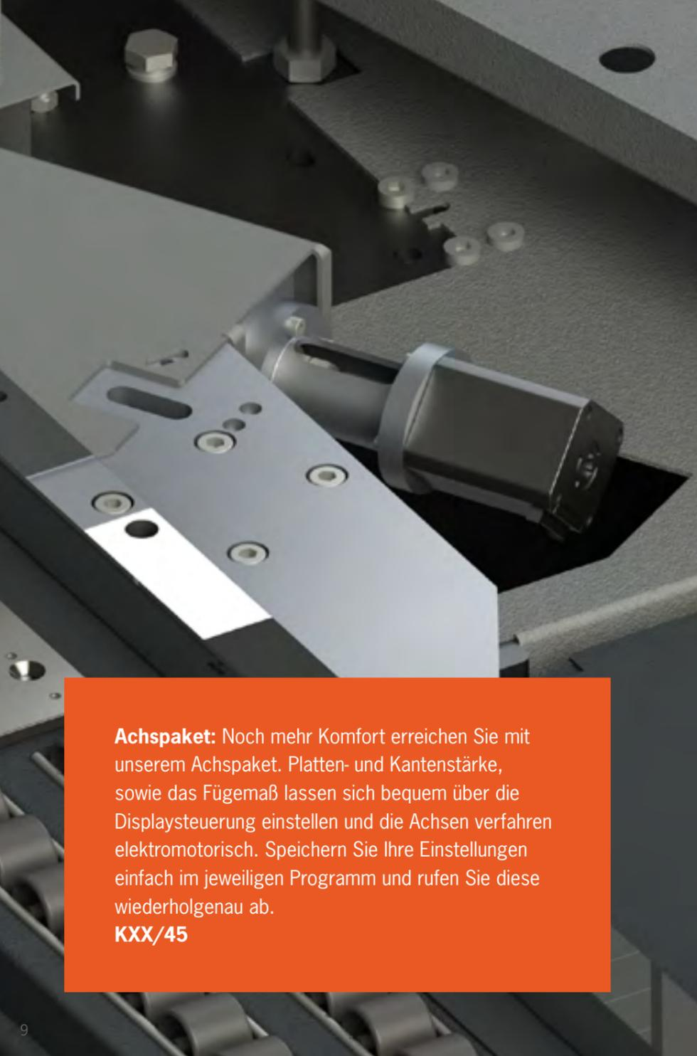
**Achspaket:** Noch mehr Komfort erreichen Sie mit unserem Achspaket. Platten- und Kantenstärke, sowie das Fügemaß lassen sich bequem über die Displaysteuerung einstellen und die Achsen verfahren elektromotorisch. Speichern Sie Ihre Einstellungen einfach im jeweiligen Programm und rufen Sie diese wiederholgenau ab.
