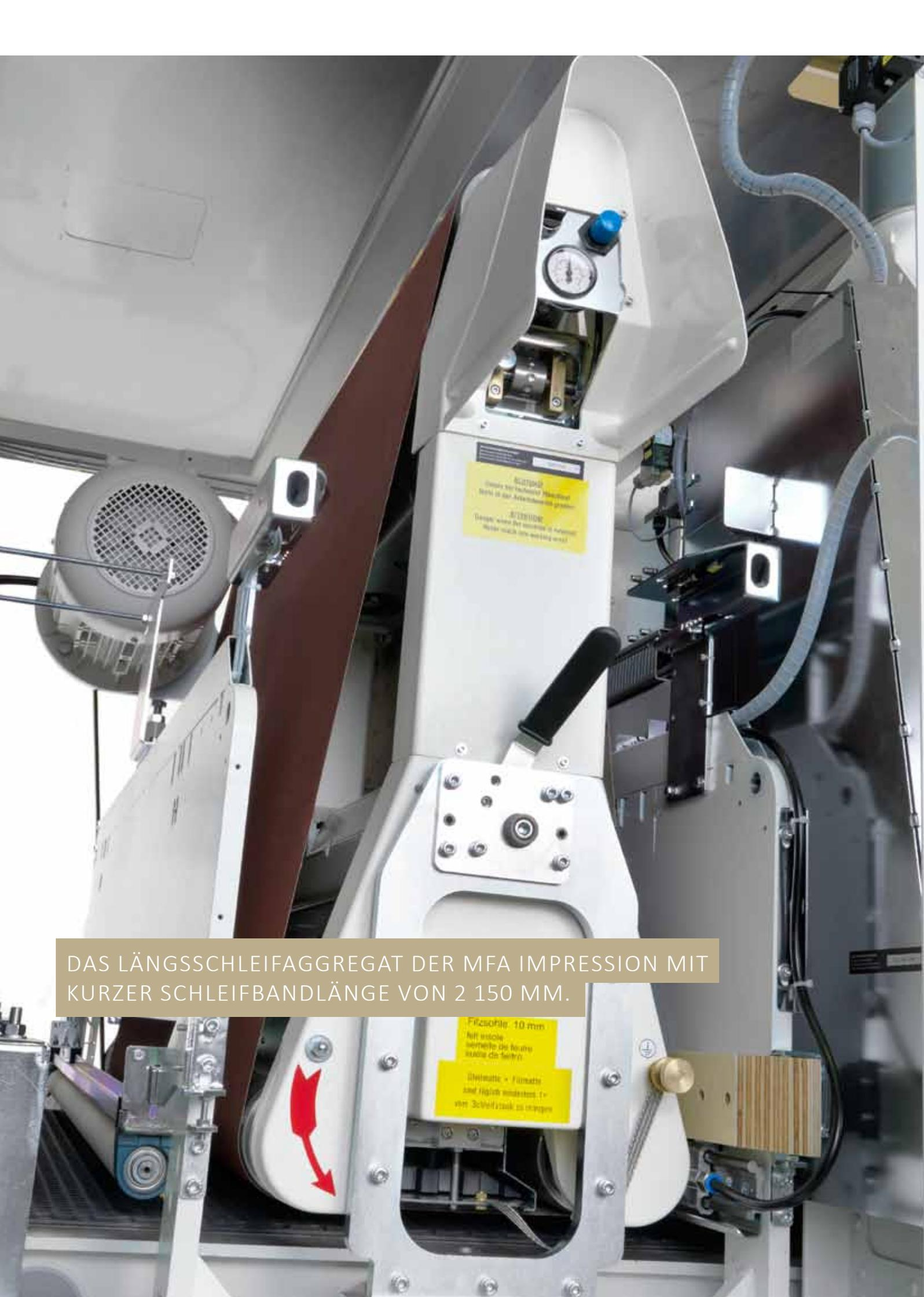
DAS LÄNGSSCHLEIFAGGREGAT DER MFA IMPRESSION MIT KURZER SCHLEIFBANDLÄNGE VON 2 150 MM.
