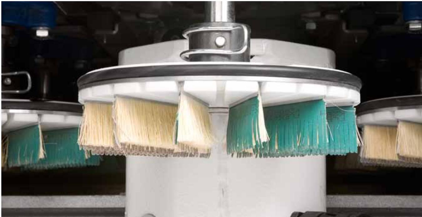
*Die Tellerbürsten des RUT-Aggregates können mit Hilfe der Schnellwechsellvorrichtung mit wenigen Handgriffen ausgetauscht werden.*
