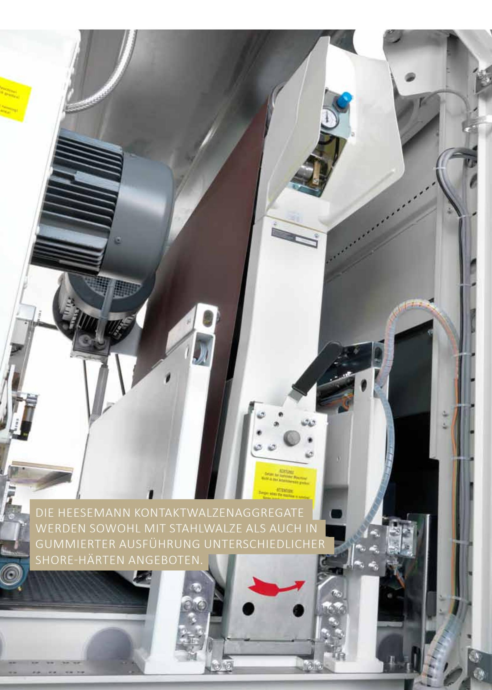
DIE HEESEMANN KONTAKTWALZENAGGREGATE WERDEN SOWOHL MIT STAHLWALZE ALS AUCH IN GUMMIERTER AUSFÜHRUNG UNTERSCHIEDLICHER SHORE-HÄRTEN ANGEBOTEN.
