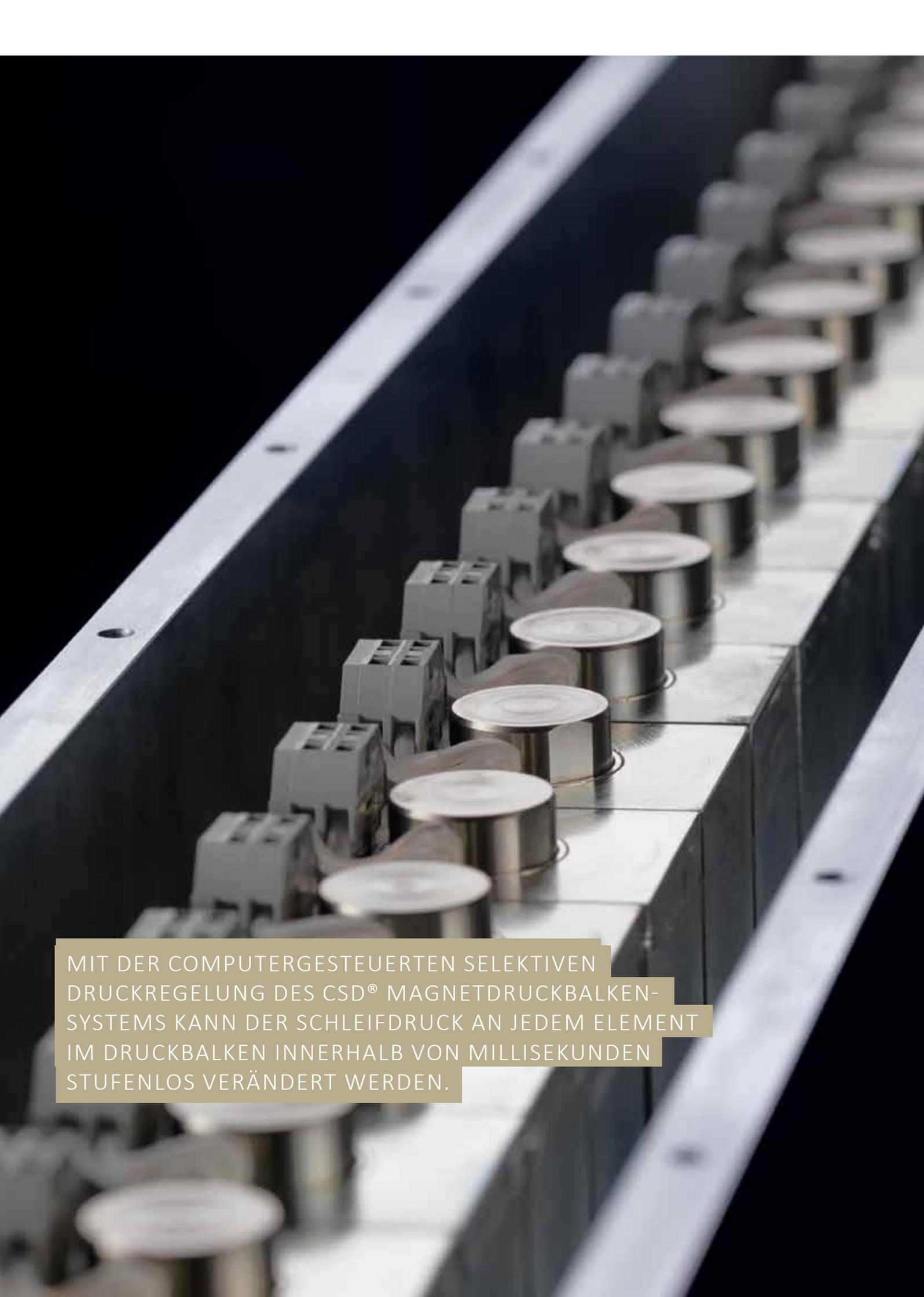
MIT DER COMPUTERGESTEUERTEN SELEKTIVEN DRUCKREGELUNG DES CSD® MAGNETDRUCKBALKEN-SYSTEMS KANN DER SCHLEIFDRUCK AN JEDEM ELEMENT IM DRUCKBALKEN INNERHALB VON MILLISEKUNDEN STUFENLOS VERÄNDERT WERDEN.
