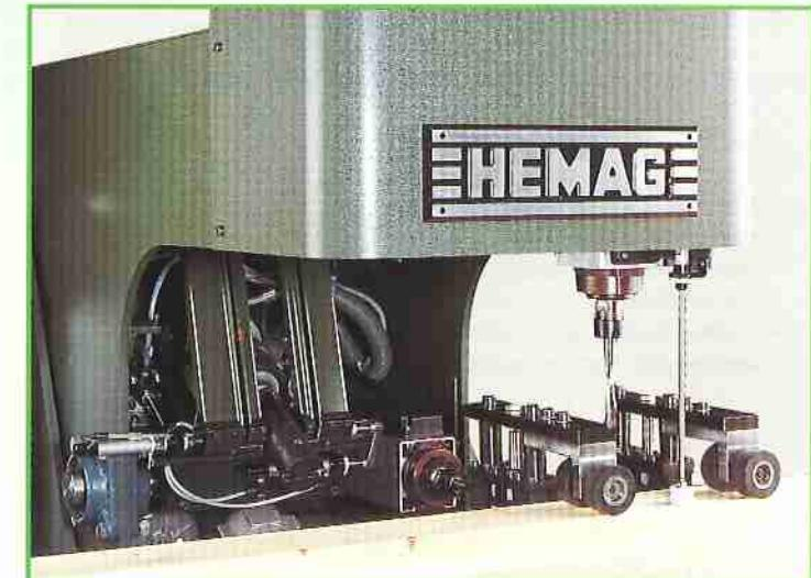
De DOR-FLEX is opgebouwd met een verticale en horizontale freesmotor van 3 pk (optie 4,5 pk) voor het uitfrezen van scharnieren, slotplaten, sloten, puntsluitingen en alle soorten standaard beschlag.
