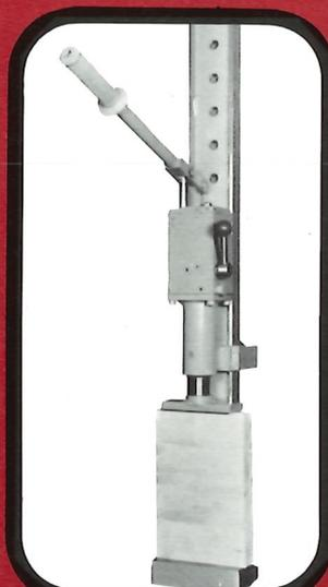
Handhydraulikzylinder mit hoher Druckleistung von ca. 2000 kp, 65 mm Zylinderhub.
